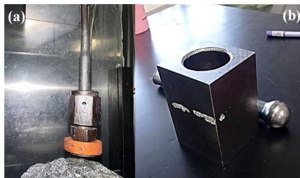
Figura 11. (a) cámara de vacío aparato de Sievert y (b) Mortero de acero inoxidable para pulverizar muestras. Fuente: elaboración propia
