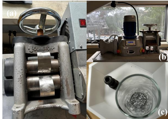
Figura 12. Equipo empleado para laminación en frío, (a) láminas, (b) máquina laminadora y (c) muestra en lámina. Fuente: elaboración propia
