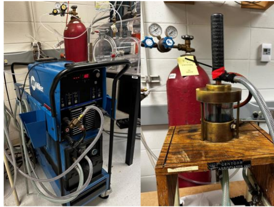
Figura 9. Máquina de arco de fusión con electrodo de tungsteno.
