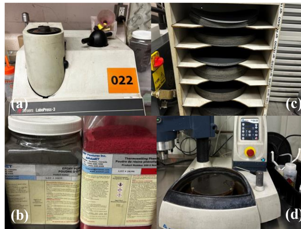
Figura 16. Máquinas y equipo empleado para preparación de muestras para SEM, (a) Struers LaboPress-3, (b) epoxi y polvo fenólico termoestable, (c) lijas y (d) Pulidora EcoMet 250. Fuente: elaboración propia
