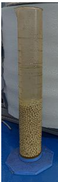
Figura 27. Probeta marca Nalgene con resolución de 10mL e incertidumbre de \pm 5ml, con material filtrante y agua en su interior.
