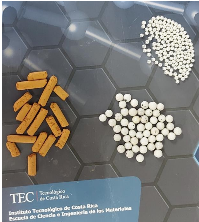
Figura 42. Visualización de algunos materiales filtrantes para aumentar el área superficial de las reacciones químicas de filtración del Biogás.
