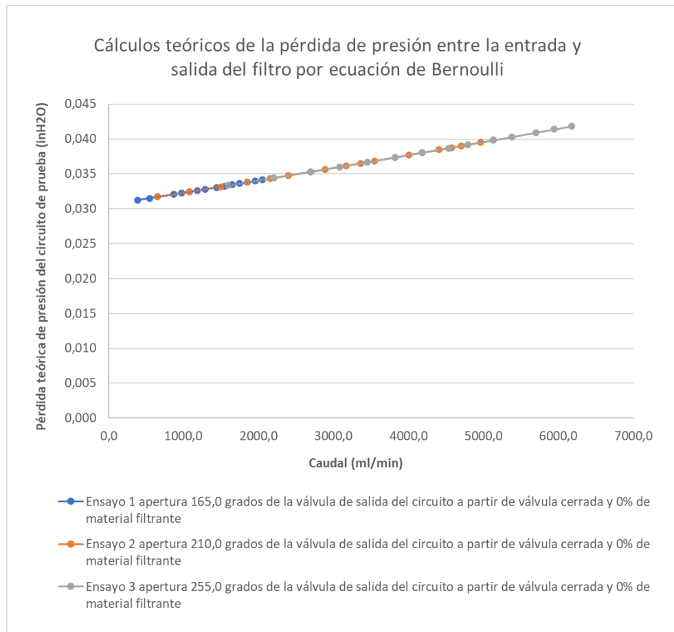
Figura 22. Cálculos teóricos de la pérdida de presión entre la entrada y salida del filtro por ecuación de Bernoulli con 0% de material filtrante.
