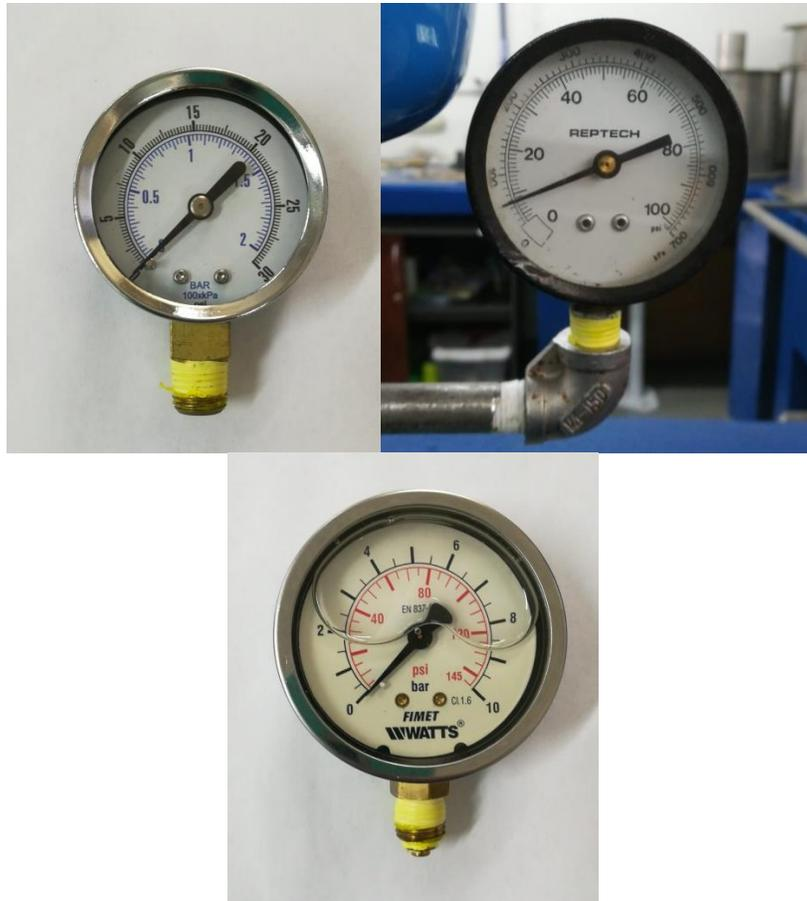
**Figura 18.** Manómetros de ajuste grueso. Elaboración propia.
