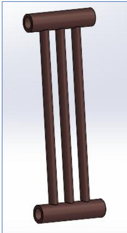
**Figura 33.** Conducto de agua diseñado y fabricado en cobre. Elaboración propia
