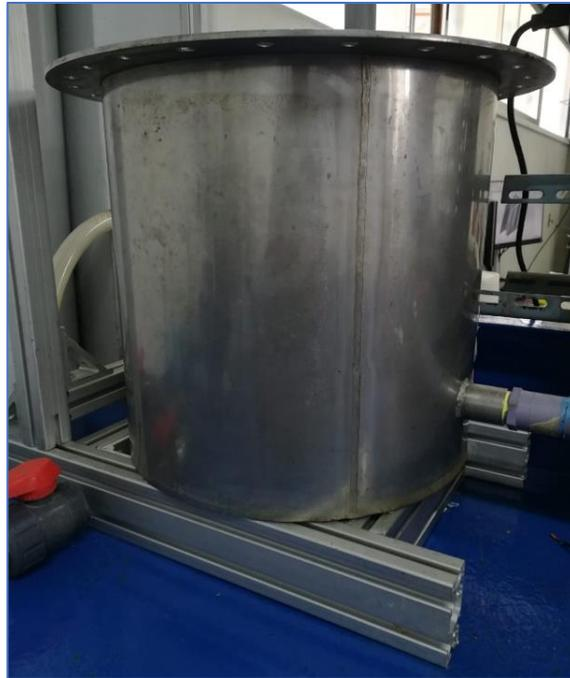
**Figura 15.** Tanque de agua de acero inoxidable. Elaboración propia.
