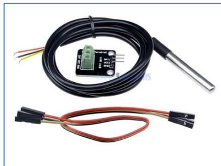
**Figura 12.** Sensor de temperatura DALLAS DS18B20. Elaboración propia.
