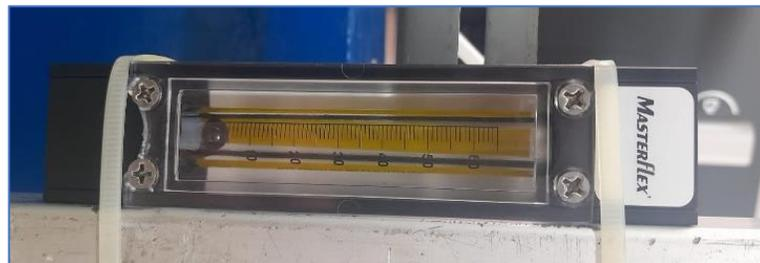
**Figura 9.** Caudalímetro MasterFlex MFLX03266-28. Elaboración propia.
