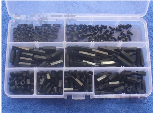
Figura 4. 17. Kit de tornillos, separadores y tuercas de nylon elegido para el diseño. [33]
