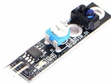
Figura 4. 8. Módulo de sensor infrarrojo inferior seleccionado. [33]
