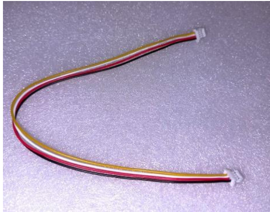
Figura 4. 15. Cable Qwiic macho-macho elegido para el diseño. [33]
