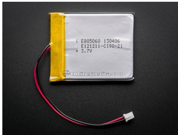
Figura 4. 3. Batería de litio de 2500mAh elegida para el diseño. [33]
