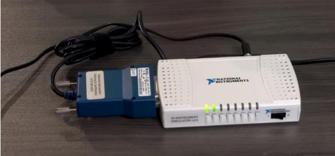
**Figura 3.** NI-GPIB-USB-HS [Elaboración propia]
