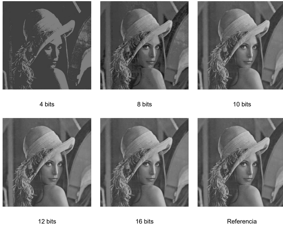
Figura 5.3. Resultados de la convolución depthwise según el tamaño de dato para un tamaño de parte entera de 2.
