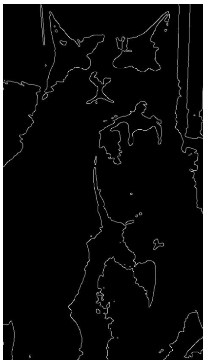
Figura 2. 20. Detección de bordes. Fuente: Elaboración propia.
