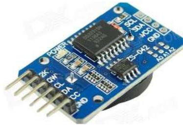
Figura 4.11: Módulo de RTC DS3231. [13].
