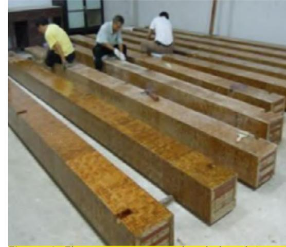
Figura 6: Elementos estructurales de bambú laminado.
