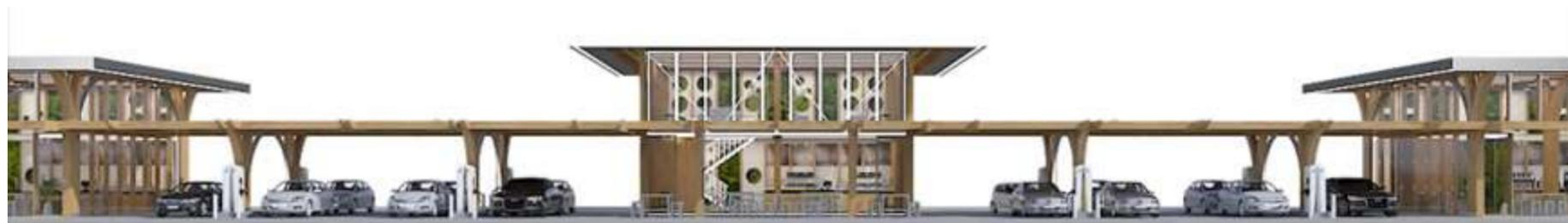
Figura 47: Proyecto Solis Pivot, diseño realizado con bambú laminado.
