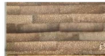
Figura 38: Bambú guadua laminado pegado prensado.
