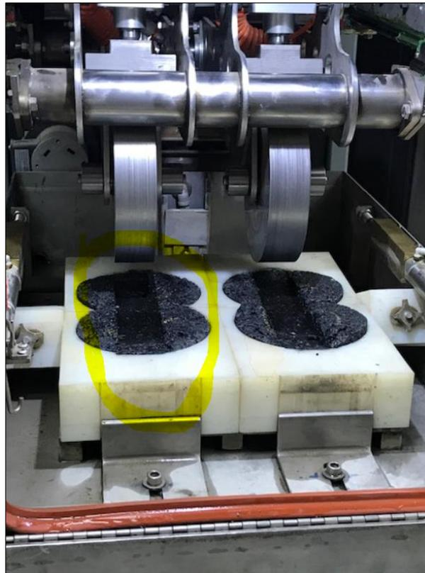
*Figura 32. Unidad de muestreo una pista compuesta por dos especímenes.*
