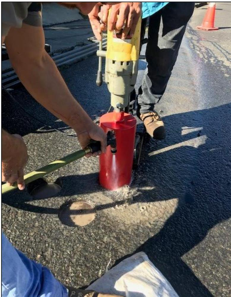
*Figura 36. Muestreo de mezcla asfáltica en camino después de la compactación en carretera en camión*
