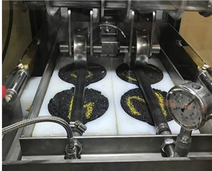
*Figura 11. Configuración del equipo para el ensayo APA
