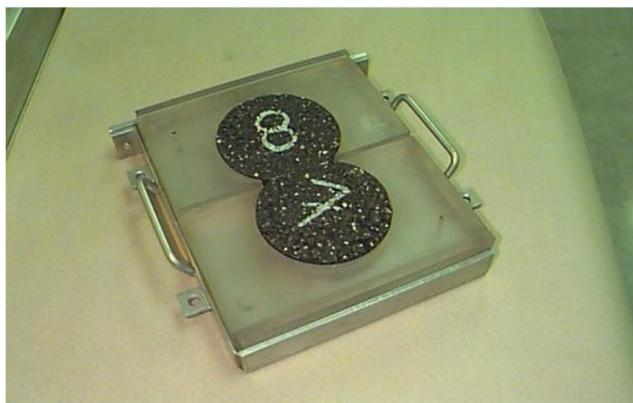
*Figura 7. Sistema de montaje de los especímenes.
