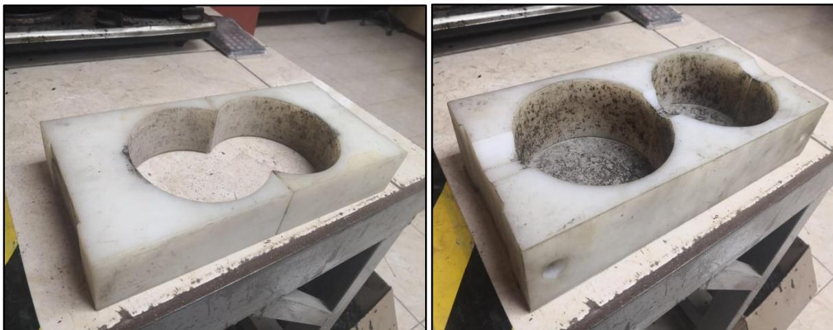
*Figura 15. Moldes para Rueda de Hamburgo (izquierda) y APA (Derecha).*
