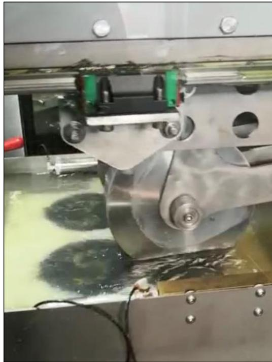
Figura 9. Ensayo de Rueda de Hamburgo en ejecución.
