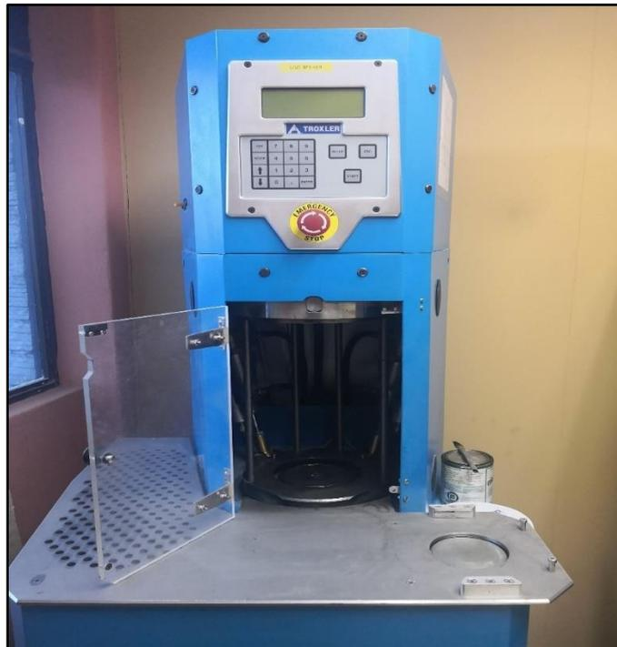
*Figura 13. Compactador Giratorio SuperPave® (SGC).*
