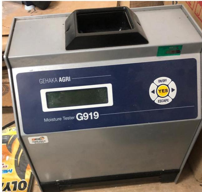
Los siguientes pasos provienen del Manual de Instrucciones del medidor de humedad, dado por el fabricante, que funciona **solo si** se usan dos muestras con su valor de humedad conocido-determinada por ejemplo por un patrón o método confiable.
