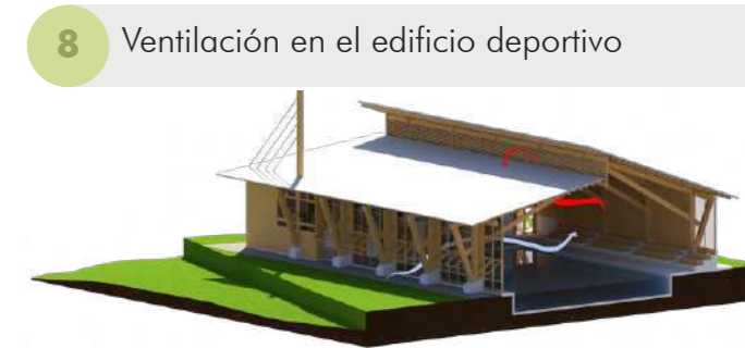
Figura 114. Diagrama de salida del aire caliente.
