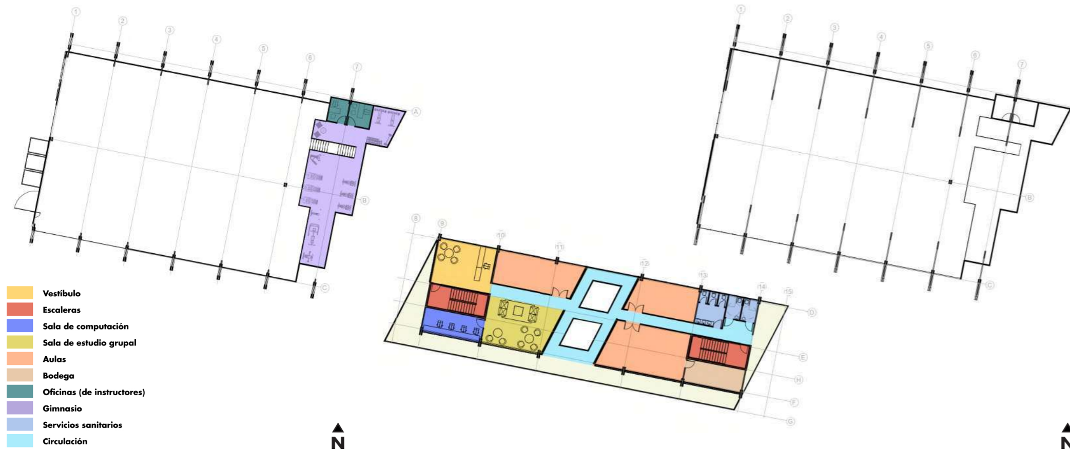
Figura 85. Planta Arquitectónica - Nivel 1.5 Escala: 1:400. Elaboración propia.
