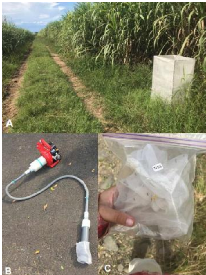
Figura 5. Instrumentos utilizados para la colecta de los insectos. A) Cuboide metálico cubierto por una malla antiáfidos adyacente al cañal; B) Equipo de aspirado
