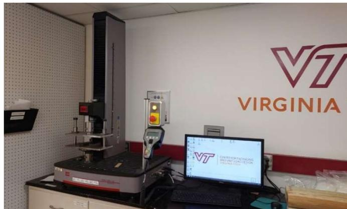
Figura 11. Equipo MTS Criterion C42-503 utilizado para las pruebas de compresión. Fuente: elaboración propia
