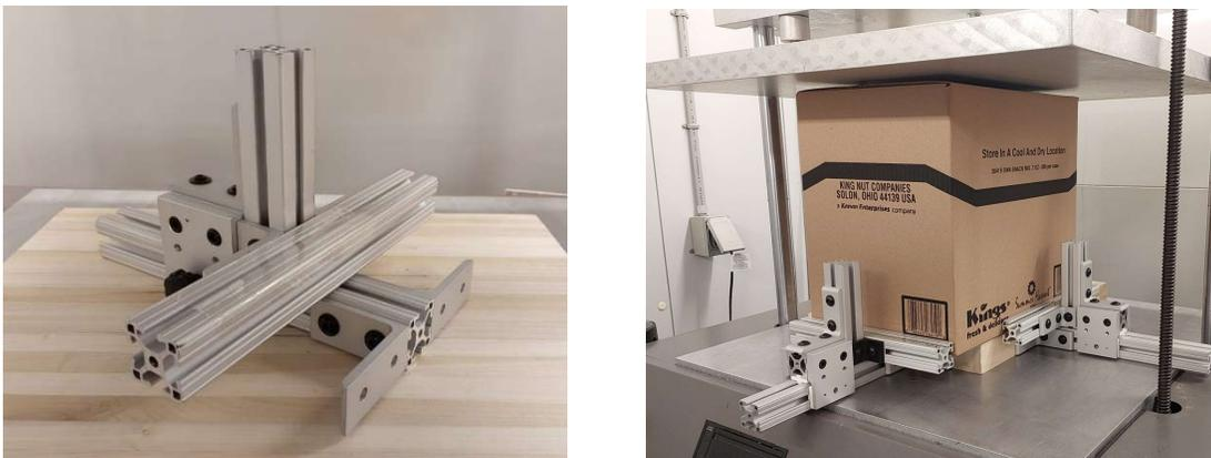
Figura 20. Guías utilizadas para ajustar la configuración de voladizo requerida.
