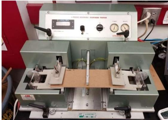
Figura 15. Etapa uno de la prueba de flexión a 4 puntos. Fuente: elaboración propia.
