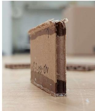
Figura 24. Muestra sometida a la prueba ECT con resultado no válido.
