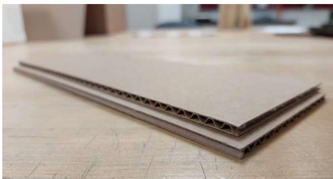
Figura 14. Muestras para pruebas de flexión a cuatro puntos en configuración MD (superior) y CD (inferior). Fuente: elaboración propia
