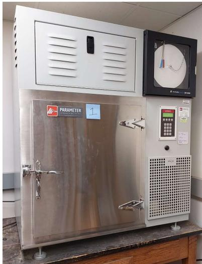
Figura 10. Cámara de acondicionamiento Parameter. Fuente: Elaboración propia.
