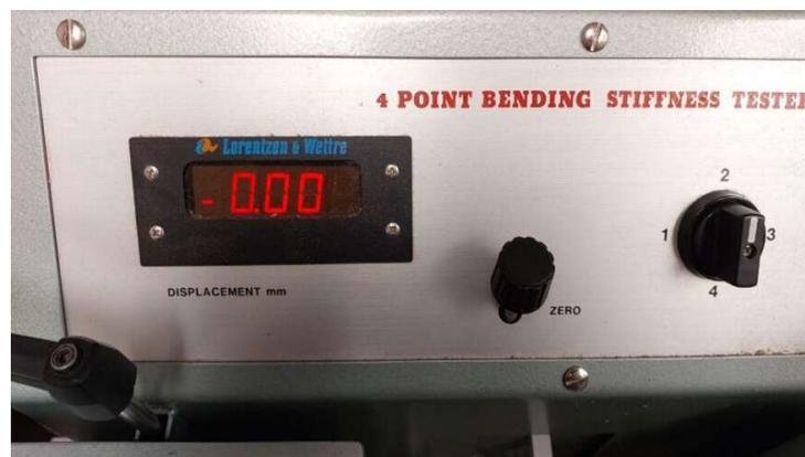
Figura 16. Panel de control del equipo L&W 4-p Bending Stiffness Tester. Fuente: elaboración propia
