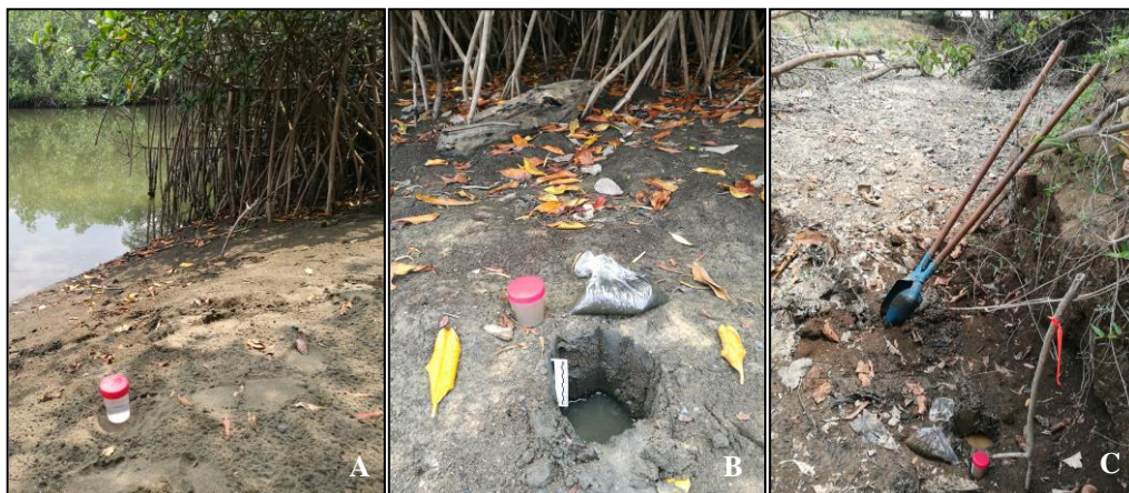
Figura 14. A. Agua recolectada en un cauce activo. B. Muestreos de agua bajo la superficie en terrenos saturados o C. cauces de ríos temporalmente secos.
