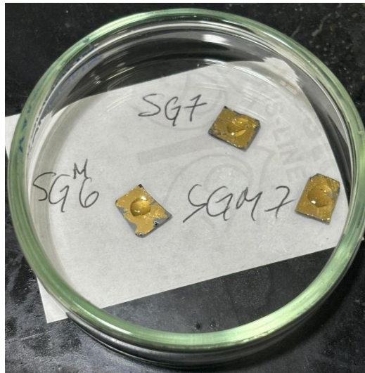
Figura 6. Deposición de aptámeros sobre chips de oro luego de aplicar el protocolo de funcionalización con la química EDC/NHS
