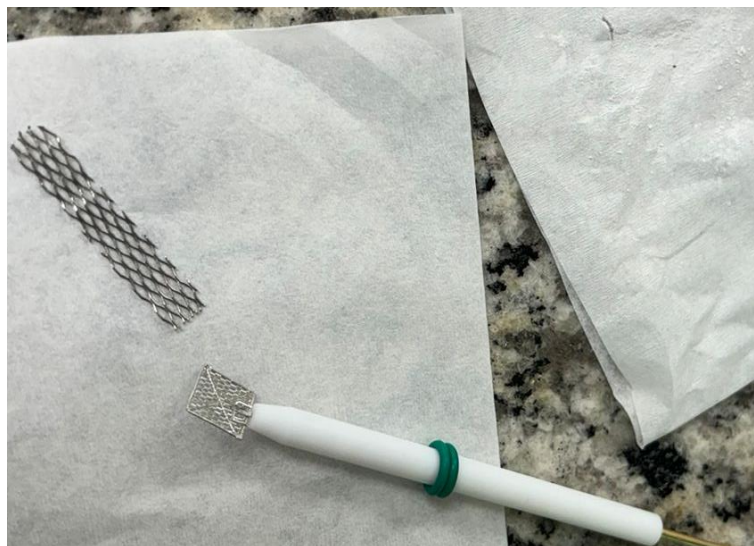
Figura 1. Pulido de electrodos de platino con alúmina
