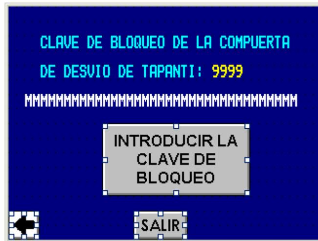
**Figura A.9.50** Pantalla de introducción de clave de bloqueo de la compuerta de Desvío de la toma de Tapantí
