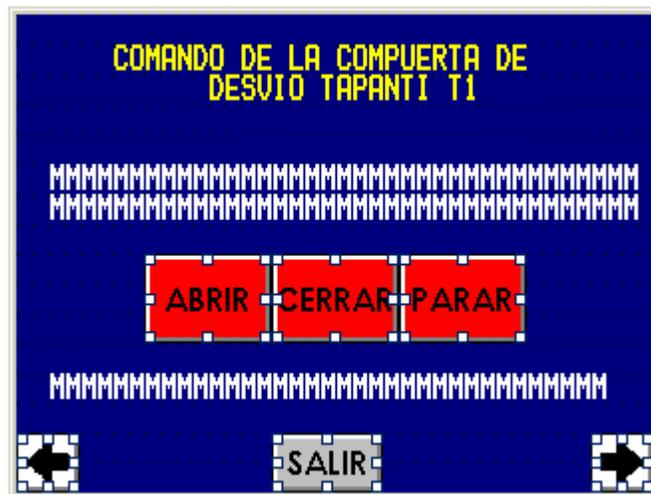
**Figura A.9.44** Pantalla de mando de compuerta T1 de Desvío de la toma de Tapantí
