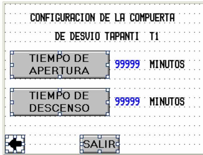
**Figura 6.3** Pantalla de configuración de tiempo de apertura y descenso de la compuerta T1 de la toma de Tapantí
