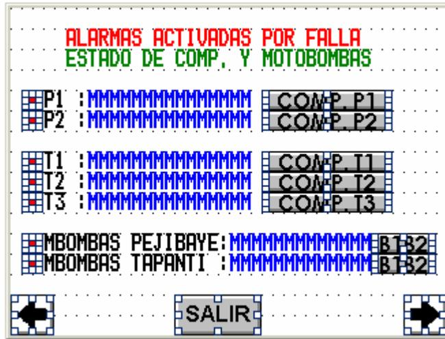
Figura A.9.15 Pantalla de alarma activada por Falla en relés térmicos de protección.
