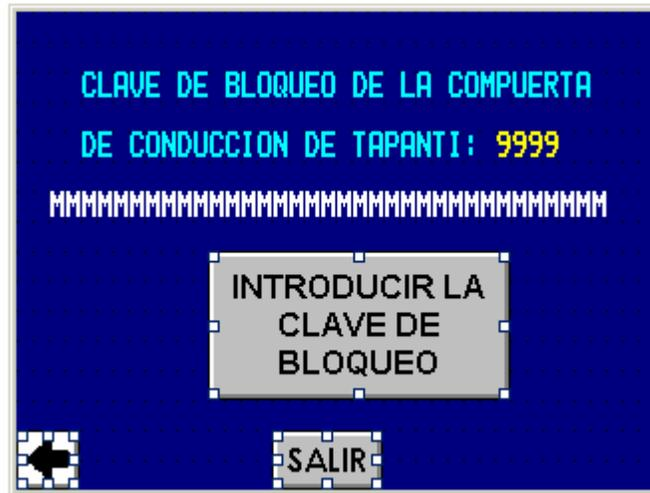
**Figura A.9.49** Pantalla de introducción de clave de bloqueo de la compuerta de conducción de la toma de Tapantí
