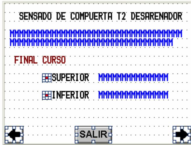
Figura A.9.71 Sensado de Finales de Carrera de la compuerta Desarenadora de la toma de Tapantí
