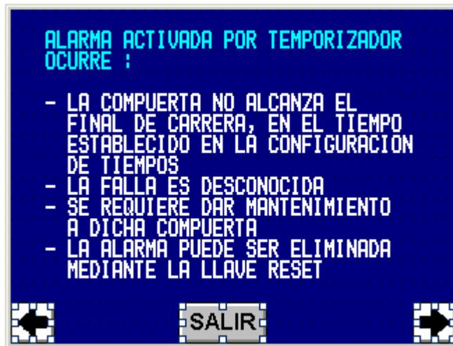
**Figura A.9.17** Pantalla del panel digital de ayuda, para alarmas activadas por temporizador.
