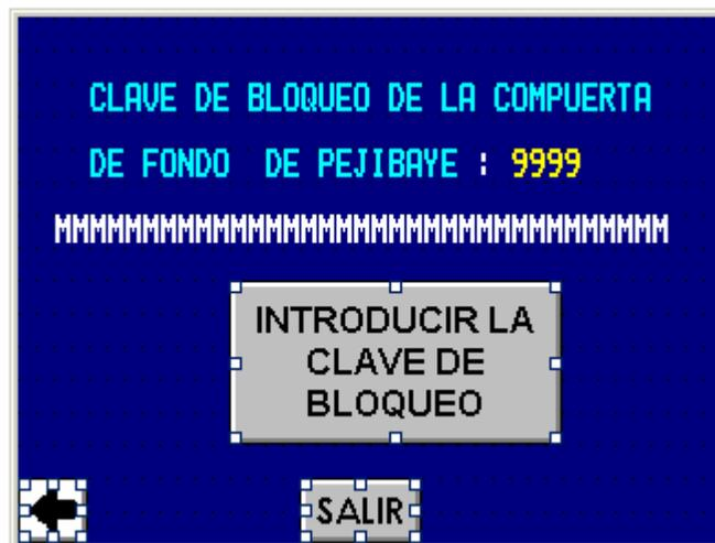
**Figura A.9.48** Pantalla de introducción de clave de bloqueo de la compuerta de Fondo de la toma de Pejibaye
