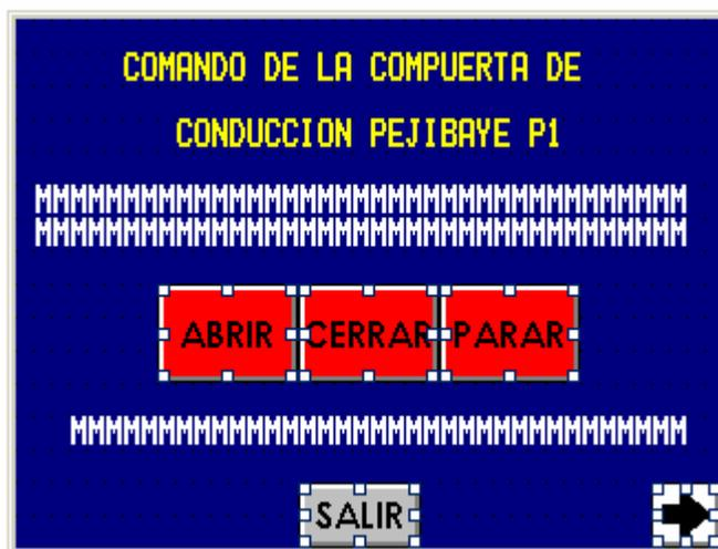
Figura A.9.42 Pantalla de mando de compuerta P1 de Fondo de la toma de Pejibaye
