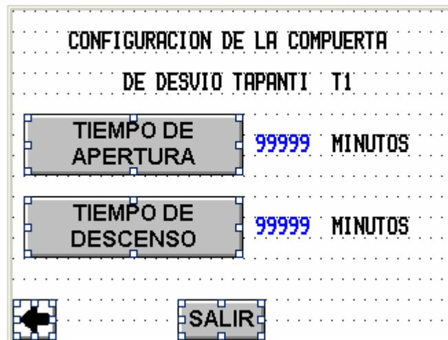
**Figura A.9.62** Pantalla de Configuración de tiempos para la compuerta de Desvío de la toma de Tapantí
