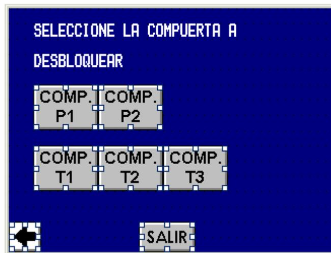
**Figura A.9.52** Pantalla de Selección de Compuerta a desbloquear
