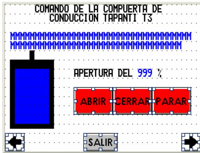
**Figura 6.1** Pantalla de mando de la compuerta de conducción de la toma de Tapantí
