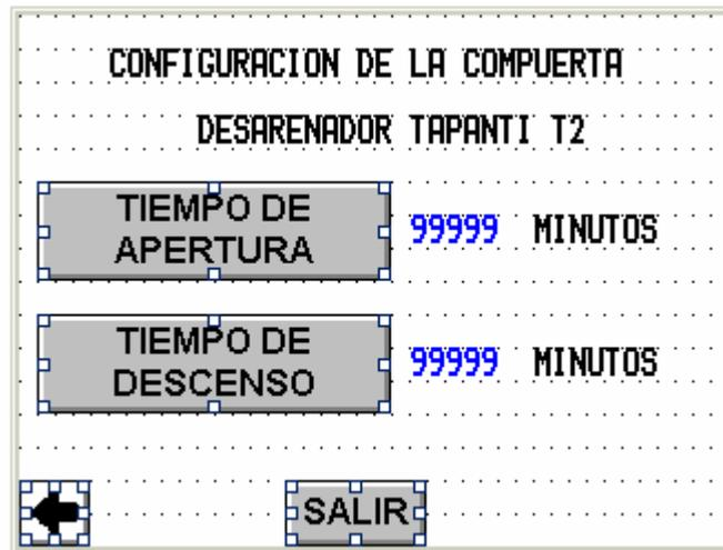
Figura A.9.63 Pantalla de Configuración de tiempos para la compuerta Desarenadora de la toma de Tapantí
