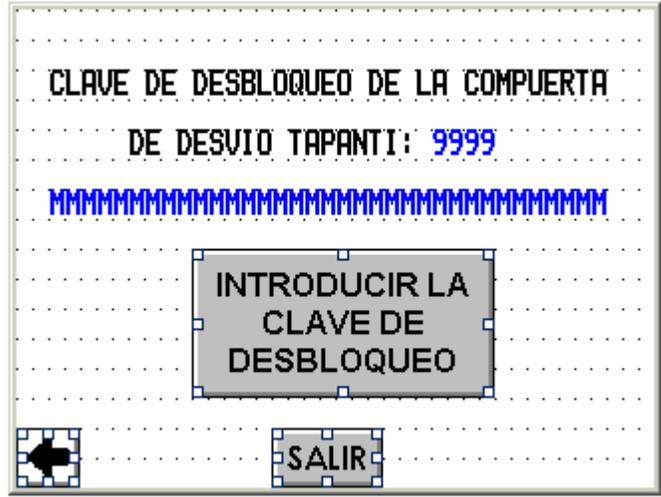
Figura A.9.56 Pantalla de introducción de clave de desbloqueo de la compuerta de Desvío de la toma de Tapantí
