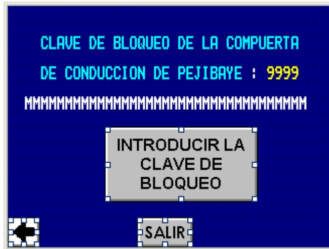
**Figura A.9.12** Pantalla del panel digital de Bloqueo de compuerta T3 de conducción de la Toma de Tapantí.
