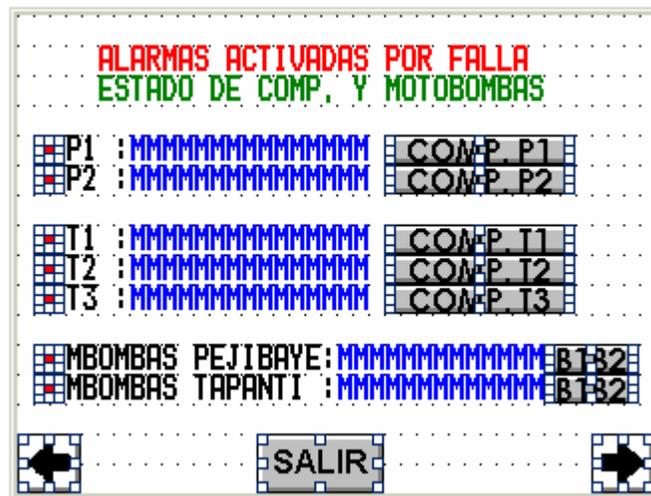
**Figura A.9.78** Pantalla de indicación, de compuerta con alarma activa por Falla
