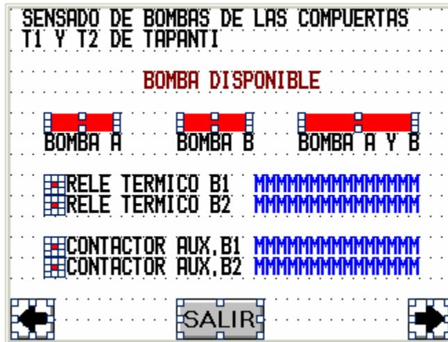
**Figura 6.2** Pantalla de sensado de bombas de las compuertas T1 y T2 de la toma de Tapantí
