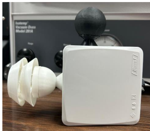
Imagen 1. Prototipo con esfera de 38mm de diámetro.
