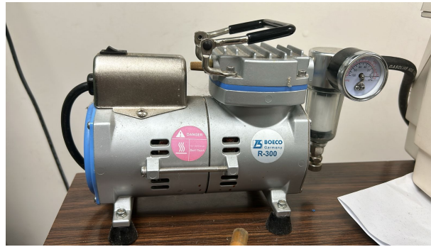
Figura 5.2: Bomba de vacío R-300.
