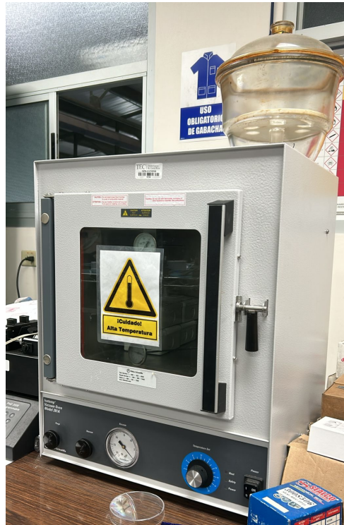
Figura 5.1: Horno de vacío.
