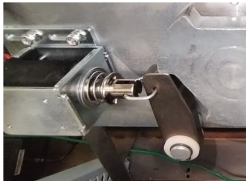
Figura 4-9. Electroimán para liberación del sistema de bloqueo del MS11G.
