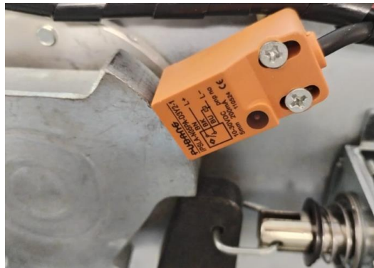
Figura 4-10. Sensor inductivo del MS11G.
