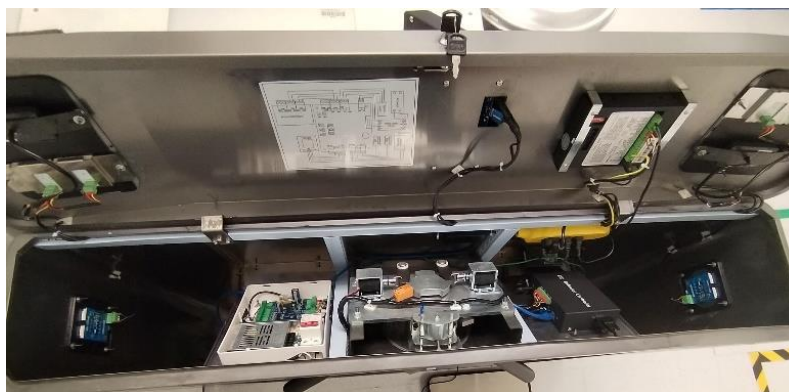
Figura 4-44. Distribución de módulos seleccionados dentro de carcasa metálica.
