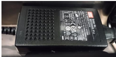
Figura 4-25. Adaptador MeanWell GST25A09-PJ1 para el probador.
