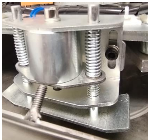
Figura 4-11. Electroimán para sujeción del brazo de bloqueo.
