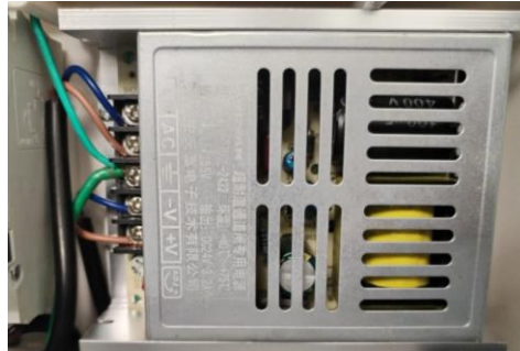
Figura 4-26. Adaptador MeanWell LRS-100-24 para tarjeta de control electromecánico.
