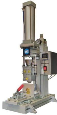
**Figura 4.** Modelo de moldeo por inyección neumático de escritorio [34].
