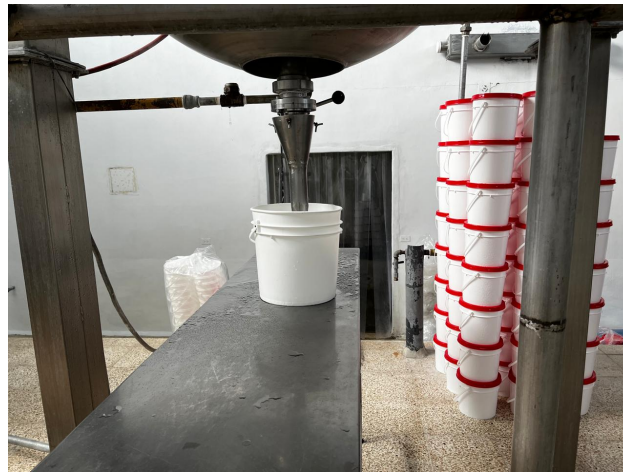
Figura 4.1: Configuración actual del llenado manual de galones de dulce de leche.
