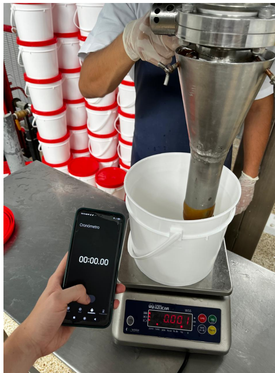
Figura 4.17: Montaje especial de medición para obtener la función de transferencia.
