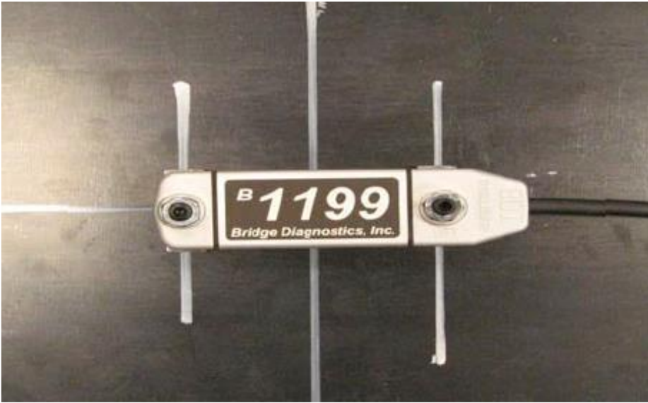
Figura 41. Montaje de sensores ST350 en vigas
