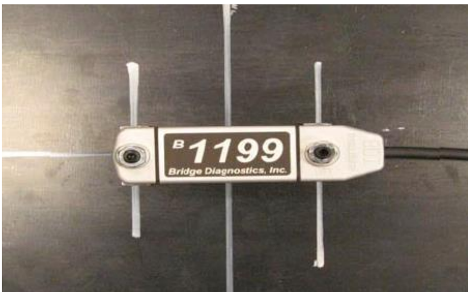
Figura 48. Montaje de sensores ST350 en vigas
