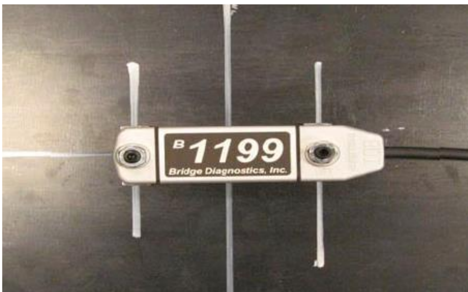
Figura 25. Montaje de sensores ST350 en vigas
