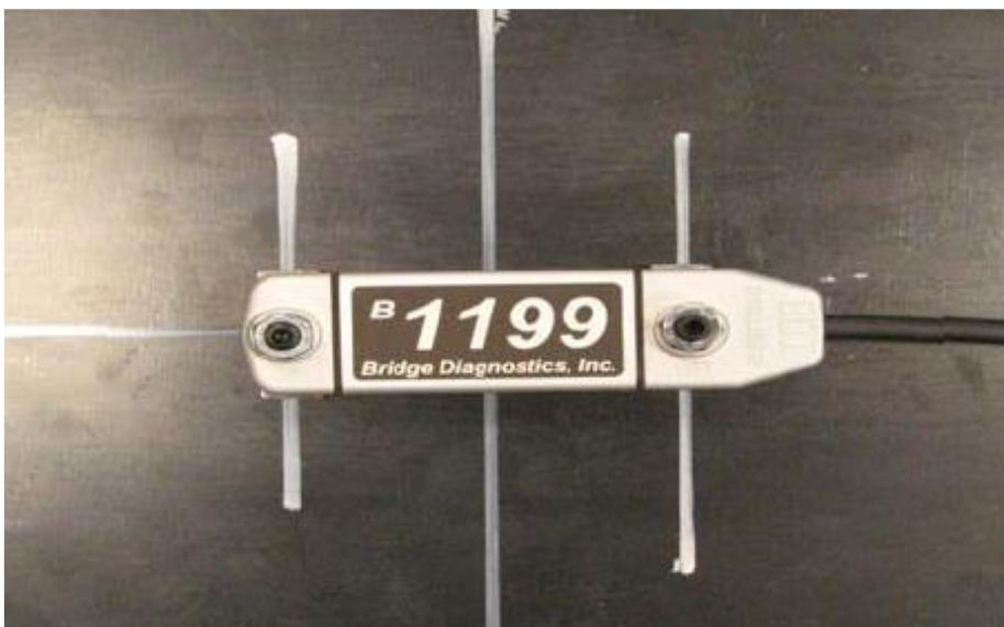
Figura 32. Montaje de sensores ST350 en vigas
