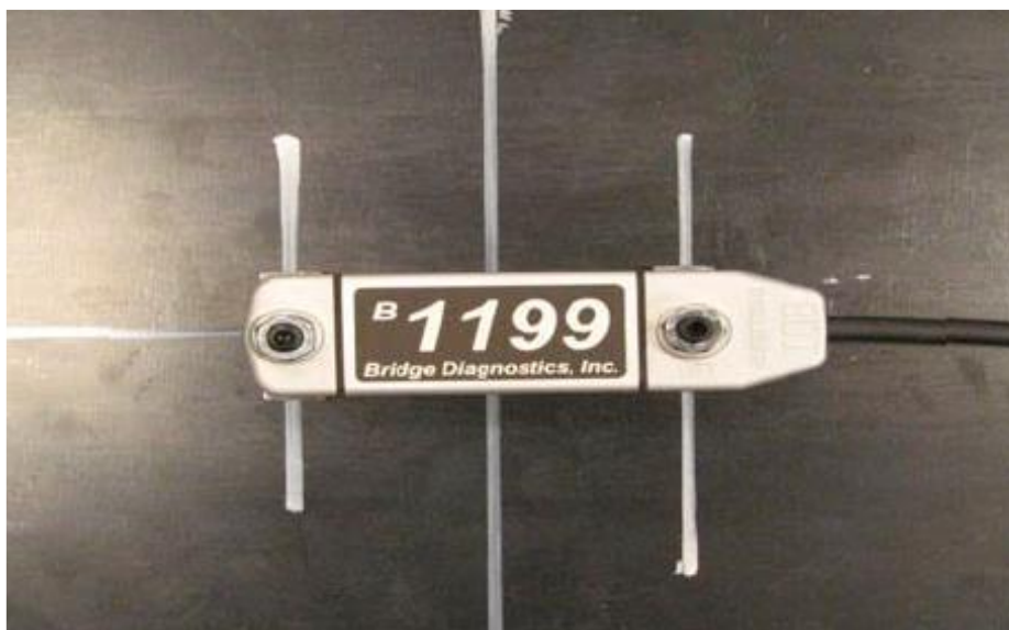
Figura 21. Montaje de sensores ST350 en vigas (fuente manual ST350 bridge diagnostic)
