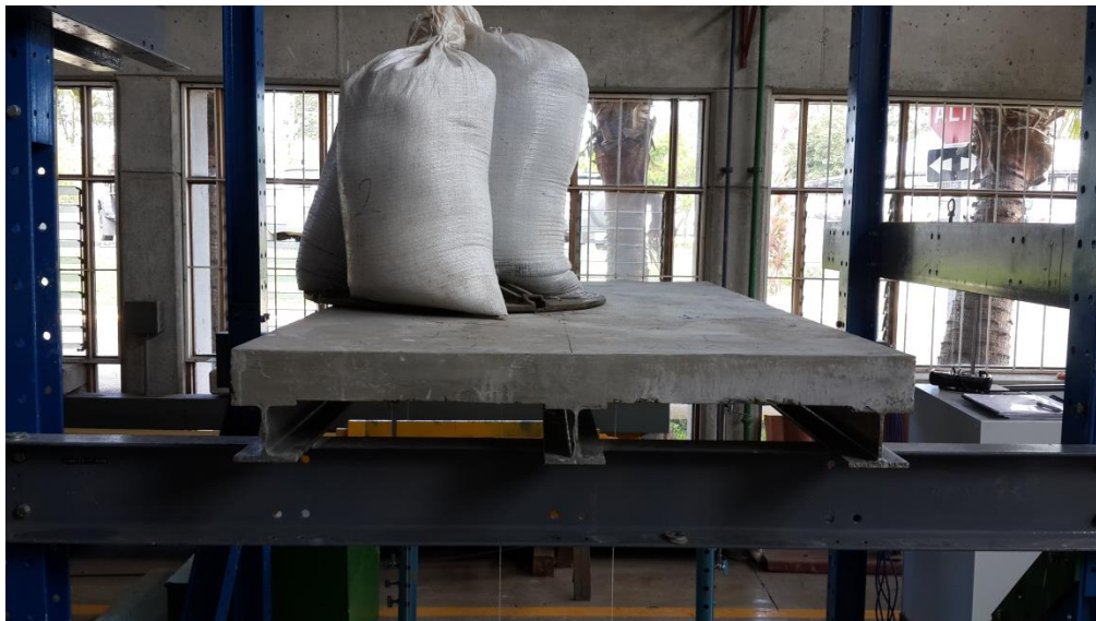
Figura 42. Puente patrón con Carga de Prueba Baja (335 Kgs).
