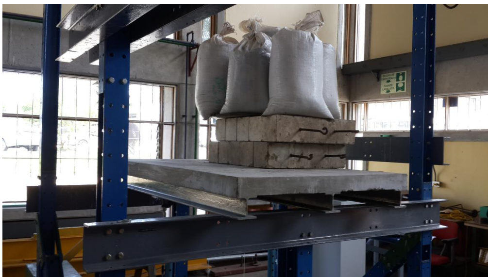
Figura 43. Puente patrón con Carga de Prueba Media (712 Kgs).
