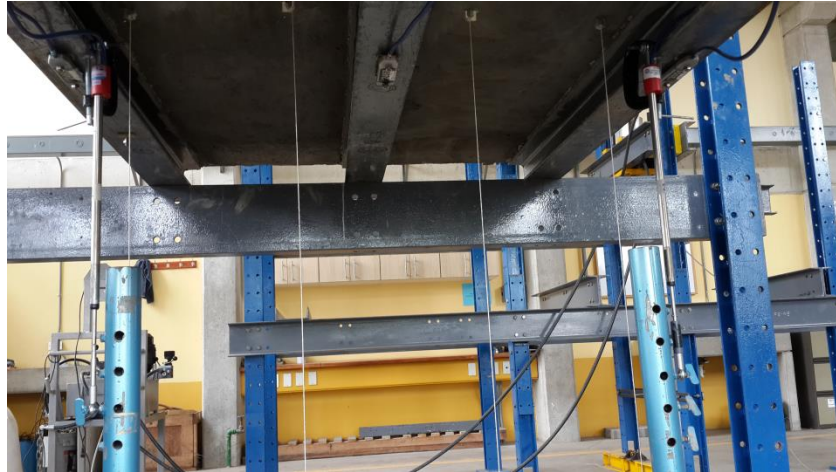
Figura 40. Instrumentación medidores de desplazamiento.
