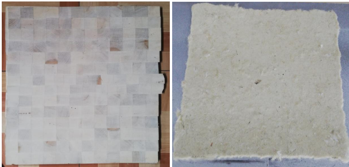
Figura 2. Paneles de madera laminada de balsa (izquierda) y paneles de fibra de piña (derecha) utilizados como almas de los tableros.
