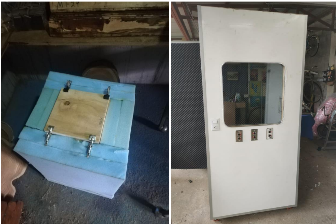
Figura 6. Cajón de insonorización (izquierda) y cámara de insonorización (derecha) utilizadas en los ensayos acústicos. Agradecimientos a HdM por el préstamo de la cámara de insonorización.
