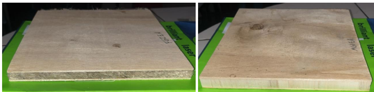
Figura 3. Resultados de los tableros de 3 capas con alma de fibra de piña (izquierda) y madera de balsa (derecha).
