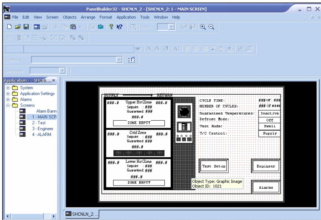
Figura 5.5 Pantalla diseñada con Panel Builder 32
