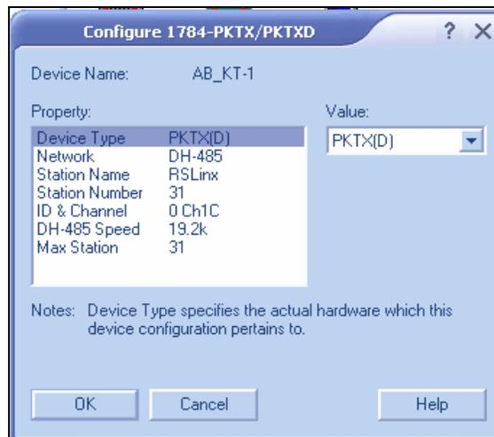
**Figura 5.2** Pantalla de configuración de interfaz de red
