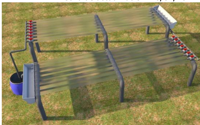
Figura 3 Diseño de reactor de capa fina para el cultivo de las microalgas
