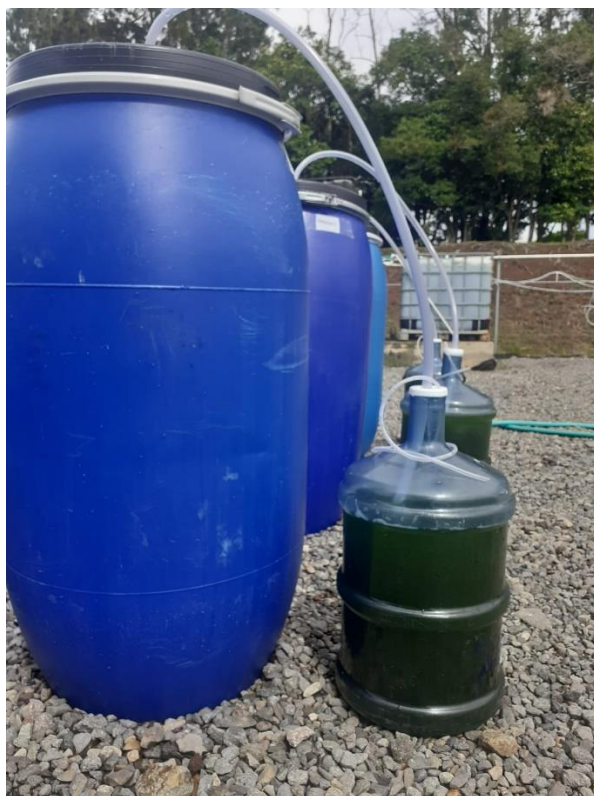
Figura 2: Cultivo del consorcio de microalgas con medio de vacaza y alimentado con el dióxido de carbono generado de la fermentación.
