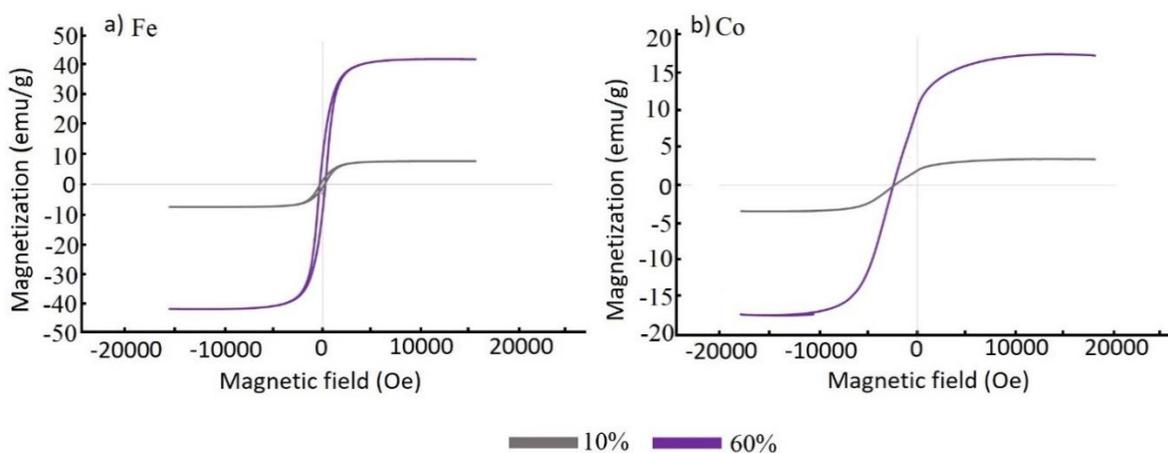
Figura 7. Curvas de histéresis magnética de dos compuestos de PLA+madera con dos proporciones de nanopartículas de hierro (a) y cobre (b).
