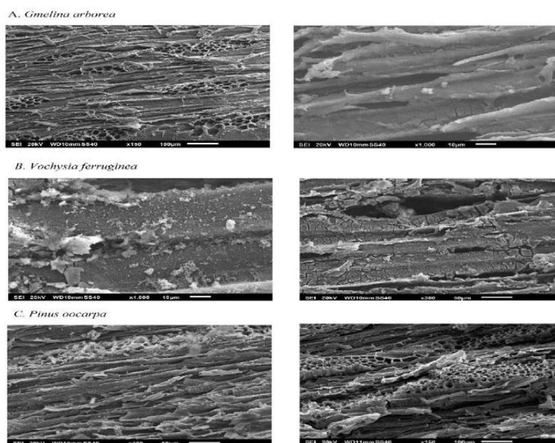
**Figura 1.** Imágenes SEM de chapas de madera magnética de tres especies tropicales (a-c) provenientes de plantaciones de rápido crecimiento en Costa Rica.
