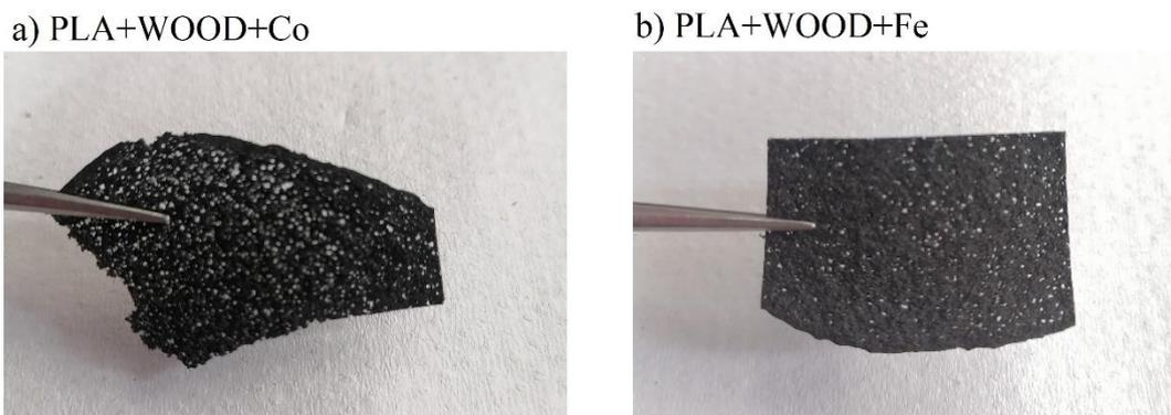
Figura 1. Imagen de biopolímero compuesto por PLA+madera+cobalto (a) y por PLA+madera+hierro.
