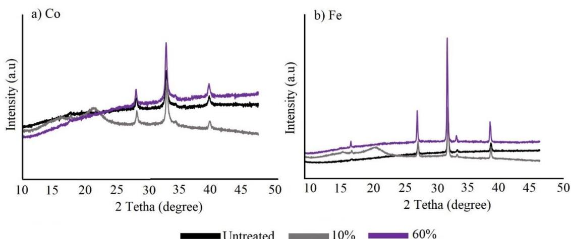
Figura 6. XDR espectro de nanopartículas dos compuestos de PLA+madera con dos proporciones de nanopartículas (c, d).
