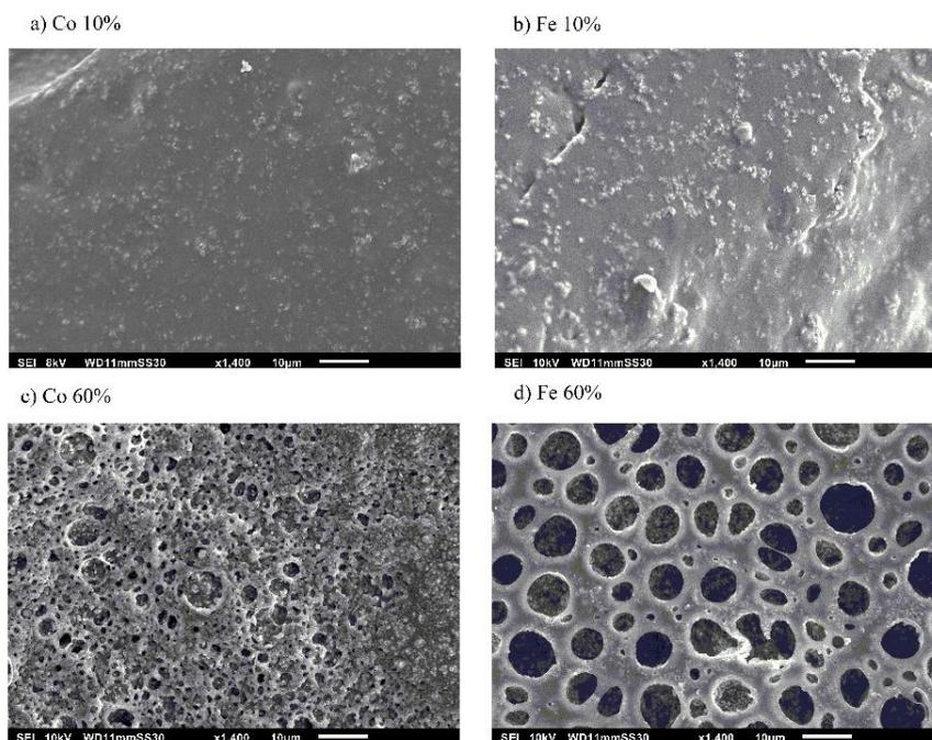
Figura 3: SEM de dos compuestos de PLA+madera con dos proporciones de nanopartículas diferentes.
