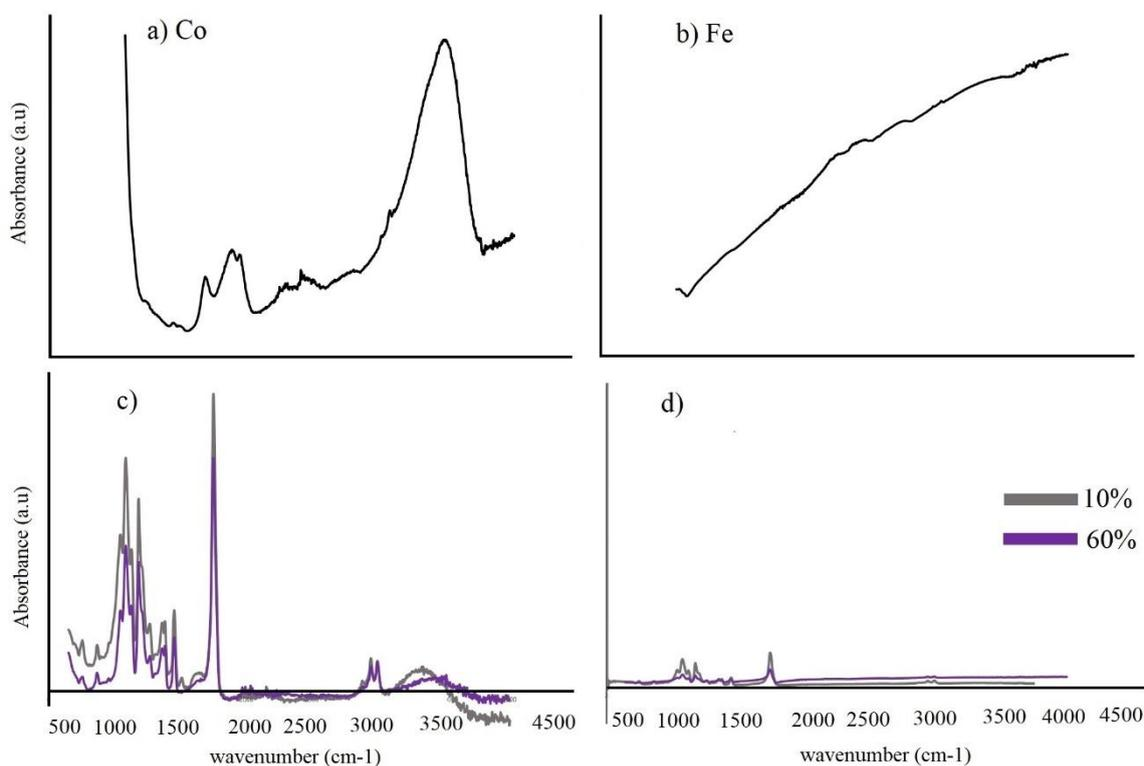
Figura 2. FTIR espectro de nanopartículas de cobalto (a), hierro (b), y dos compuestos de PLA+madera con dos proporciones de nanopartículas (c, d).
