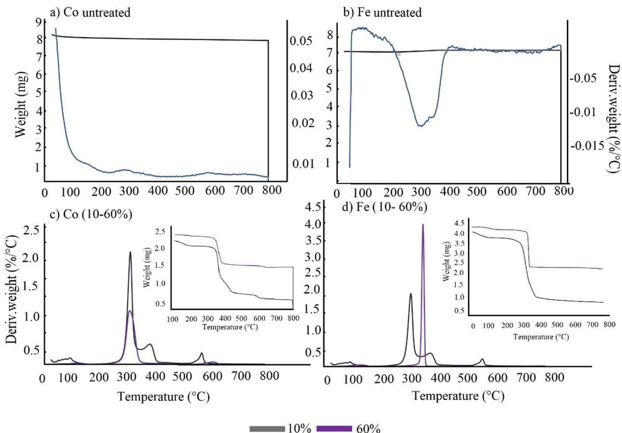
Figura 5. Análisis TGA y DTG, de nanopartículas de cobalto (a), hierro (b), y dos compuestos de PLA+madera con dos proporciones de nanopartículas (c, d).
