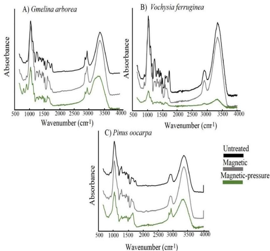
**Figura 2.** Espectro FTIR de chapas de madera magnética de tres especies tropicales (a-c) de plantaciones de rápido crecimiento en Costa Rica.
