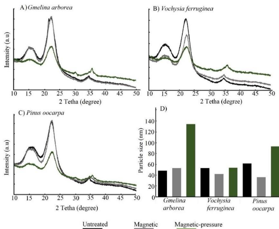
**Figura 3.** Difracción XDR de chapas de madera magnética de tres especies tropicales (a-c) de plantaciones de rápido crecimiento en Costa Rica.
