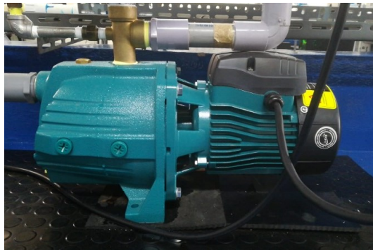
Figura 6.23. Bomba a chorro DAB, modelo LEO AJM75.
