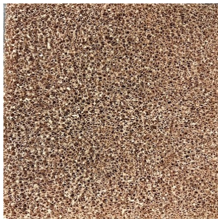
Figura 7.1. Esponja metálica de cobre del intercambiador de calor.
