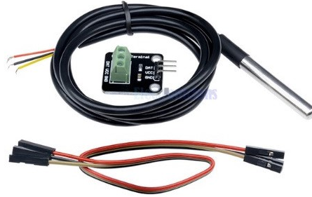
Figura 6.22. Sensor de temperatura DALLAS DS18B20.
