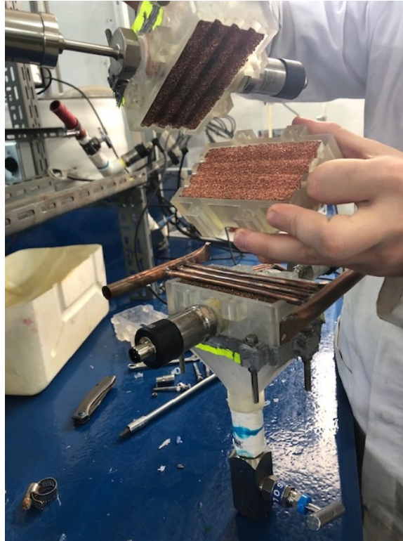
Figura 6.11. Componentes del intercambiador de calor compacto con esponjas metálicas.
