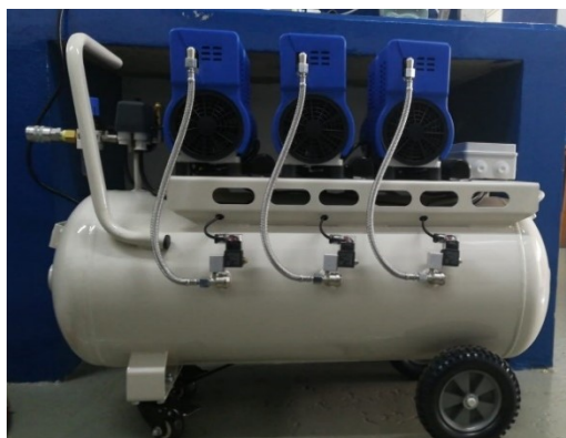
Figura 6.15. Compresor de aire BAMBI PT90.
