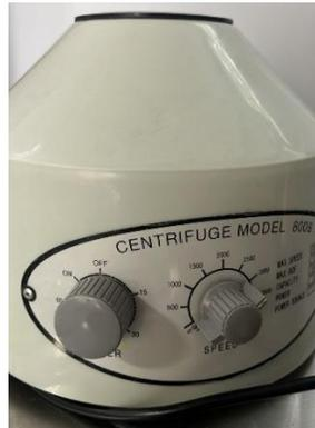
Figura 2. Centrifugadora modelo 800B utilizada para la separación del suero y coágulo sanguíneo. Foto por Randal Guerrero.
