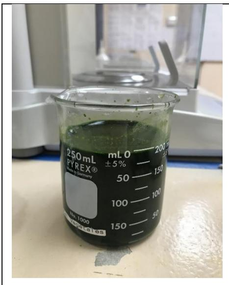
**Figura 3.** Cosecha de la biomasa de *Isochrysis galbana* por centrifugación. Volumen final obtenido del biorreactor *Applikon Biotechnology* de 15 L.
