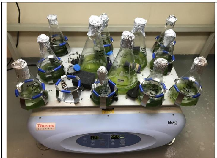
**Figura 1.** Inóculos de *Isochrysis galbana* y *Chlorella vulgaris* en Erlenmeyer de 250 mL, 1000 mL y 2000 mL con volumen de cultivo de 25 mL, 100 mL y 200 mL respectivamente, en agitación a 120 rpm, para facilitar la aireación y mezcla de nutrientes.
