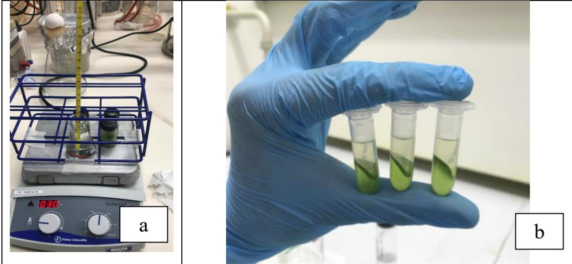
**Figura 4** (a). Ensayo preliminar para la extracción de lípidos totales (Temperatura 30°C, agitación constante a 500 rpm por 24 h) por el método de Folch. (b). Extracciones a partir de biomasa de microalgas en cloroformo/metanol (en proporción 2/1 respectivamente).
