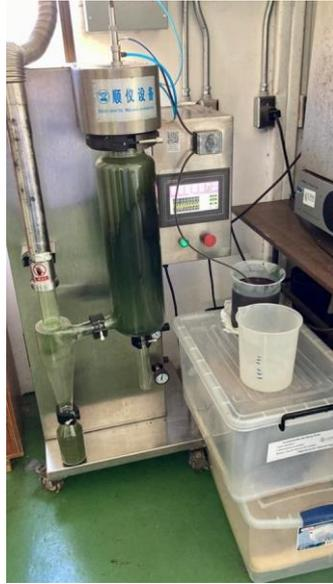
**Figura 2.** Sistema de secado de la biomasa por spray dryer.
