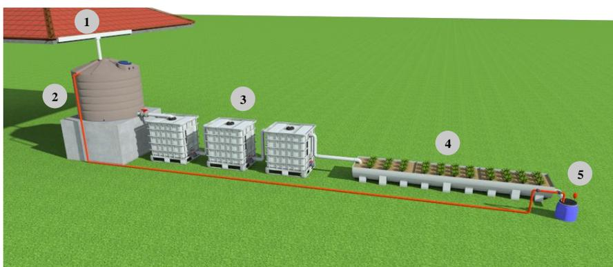
**Figura 1.** Representación global del proceso. (1) Captación de agua de lluvia. (2) Almacenamiento. (3) Tanquetas de cultivo. (4) Humedal acuapónico. (5) Tanque de bombeo para recirculación.
