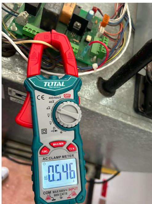
Figura XXII: Medición de la corriente del ventilador utilizando un multímetro de gancho
