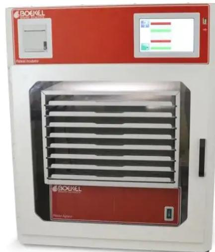
Figura LXIV: Incubadora de plaquetas modelo 301300 marca Boekel Scientific
