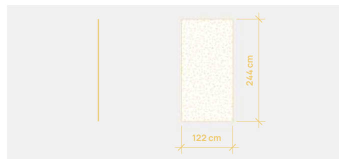
Figura 110. Dimensión básica de una lámina liviana de pared de yeso o fibrocemento. Fuente: Elaboración propia.
