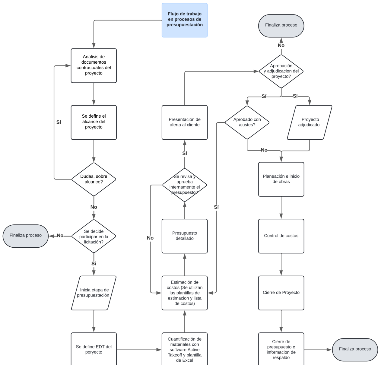
Figura 1. Diagrama de flujo de proceso de presupuestación
