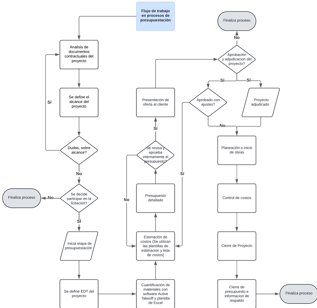
Figura 8. Diagrama de flujo de proceso de presupuestación
