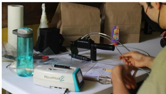
**Figura 8.** David Romero (investigador PRIAS) tomando datos de firmas hiperespectrales de hojas, recolectadas por Nelson y Sebastián, mediante el uso de un espectroradiómetro de campo ASD Handheld 2 y su Plant Probe y clip para plantas.
