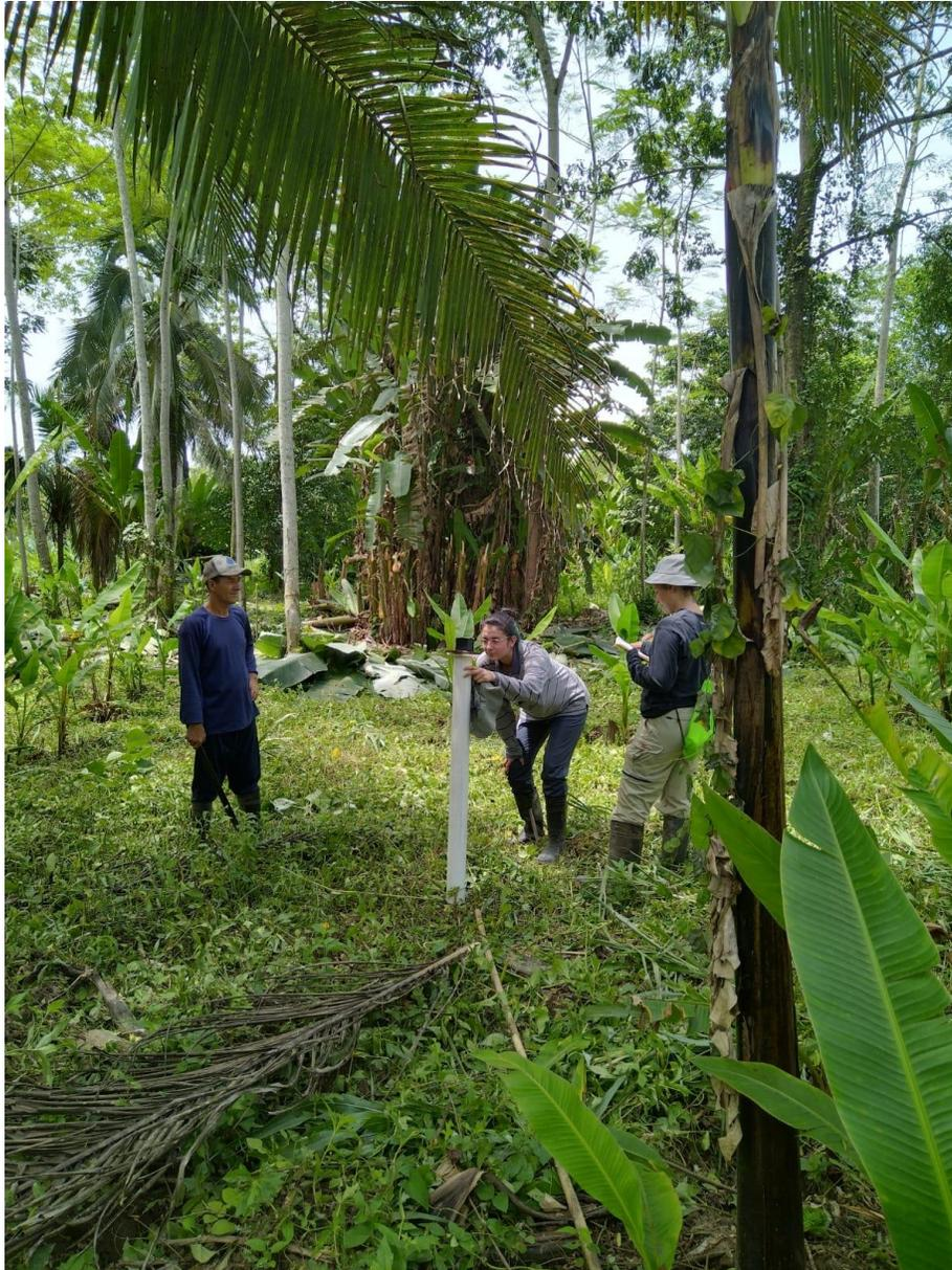
Figura 5. Campaña de mediciones de los niveles de luz con diferentes instrumentos, en este caso utilizando un densiómetro de copas.
