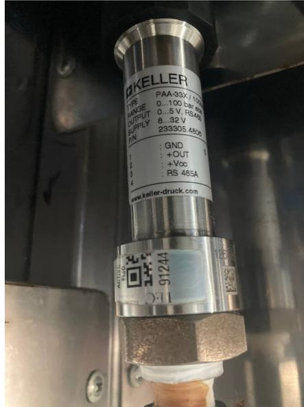
**Figura 4.19:** Transmisor de presión KELLER Serie 33X con interfaz RS-485.
