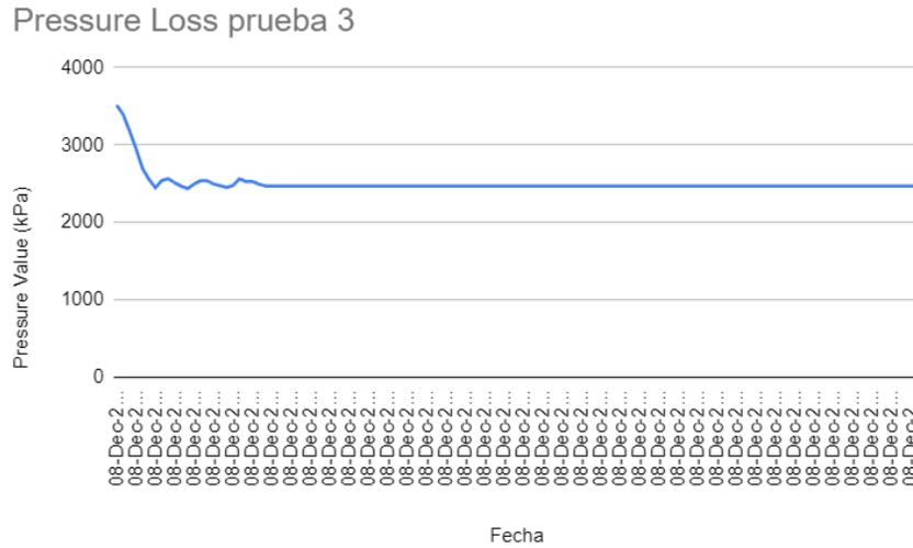
Fig. 103. Prueba 3. Simulación de pérdidas de presión. Valor inicial: 3513.7 kPa.
