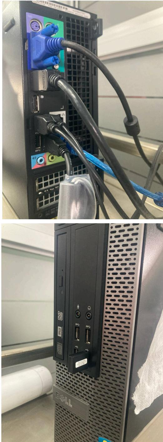
Fig. 3. Puertos COM en la computadora.
