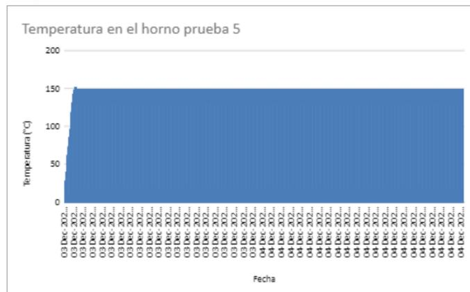
Fig. 15. Resultados prueba 5; temperatura en horno.
