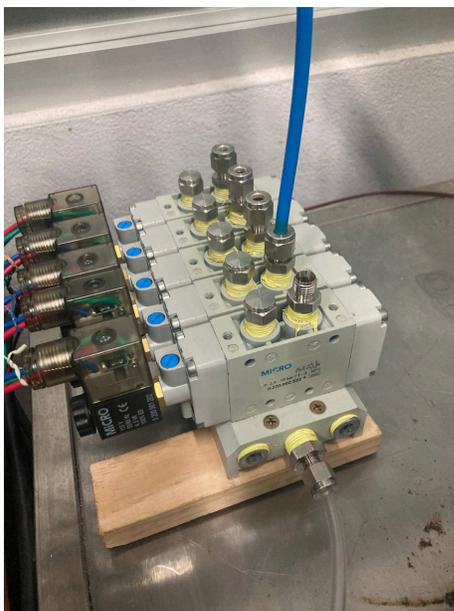
Fig. 99. Conexión manifold para prueba de tiempo de respuesta de válvula neumática.
