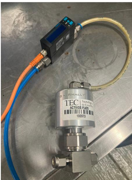
Fig. 100. Conexión sensor de flujo para prueba de tiempo de respuesta de válvula neumática.
