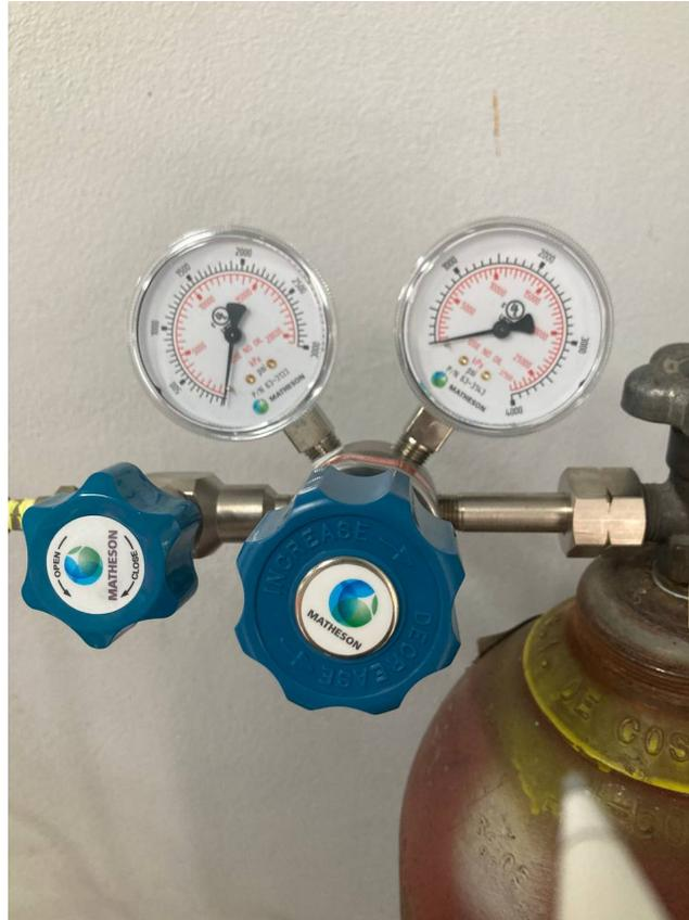
**Figura 4.31:** Regulador de flujo analógico adaptado a la salida del tanque de hidrógeno.
