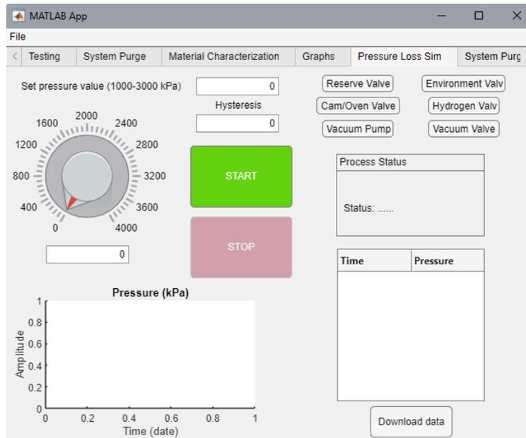
Fig. 25. Pestaña de simulación de control de presión.
