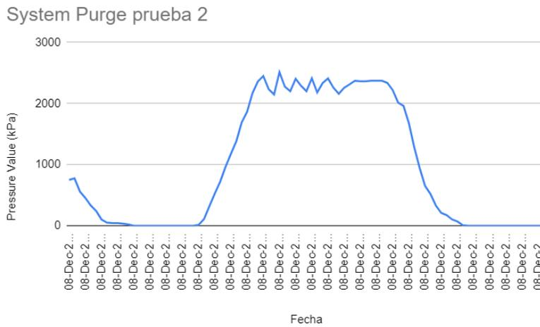
Fig. 113. Prueba 2. Simulación de purga del sistema. Valor inicial: 750.6 kPa.
