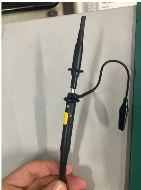
**Figura 5.4:** Sonda de prueba para osciloscopios de 60 MHz (atenuación x10).
