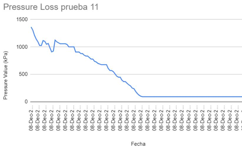
Fig. 111. Prueba 11. Simulación de pérdidas de presión. Valor inicial: 1397.8 kPa.
