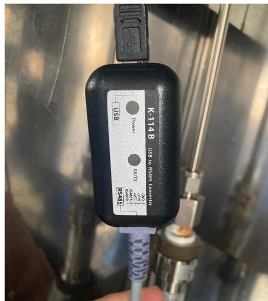
**Figura 4.20:** Convertidor A/D K-114 con interfaz RS-485 a través de USB.
