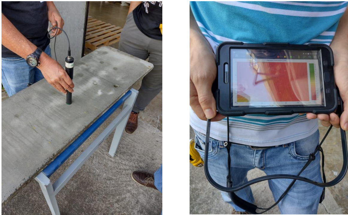
Figura 8. Ensayo de potencial de corrosión utilizando el equipo de celda media
