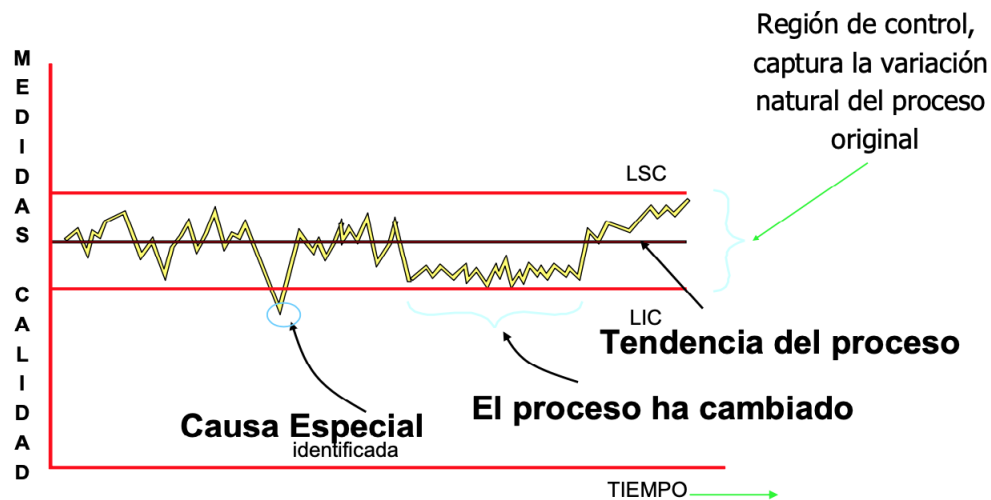
Figura 5: Patrones de anomalía en una gráfica de control. Fuente: tomado de “Control Estadístico del Proceso” [10]
