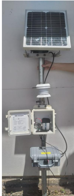
Ilustración 4- Estación total con el sensor de humedad y temperatura
