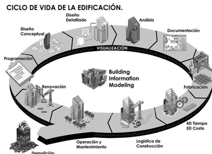
Figura 1. Representación del ciclo de vida de un proyecto constructivo.
