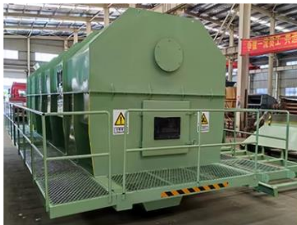
Figura V.2. Máquina de clasificación de basura de RSM. (Fuente: Henan Mind Machinery Equipment Co., Ltd., s.f.)
