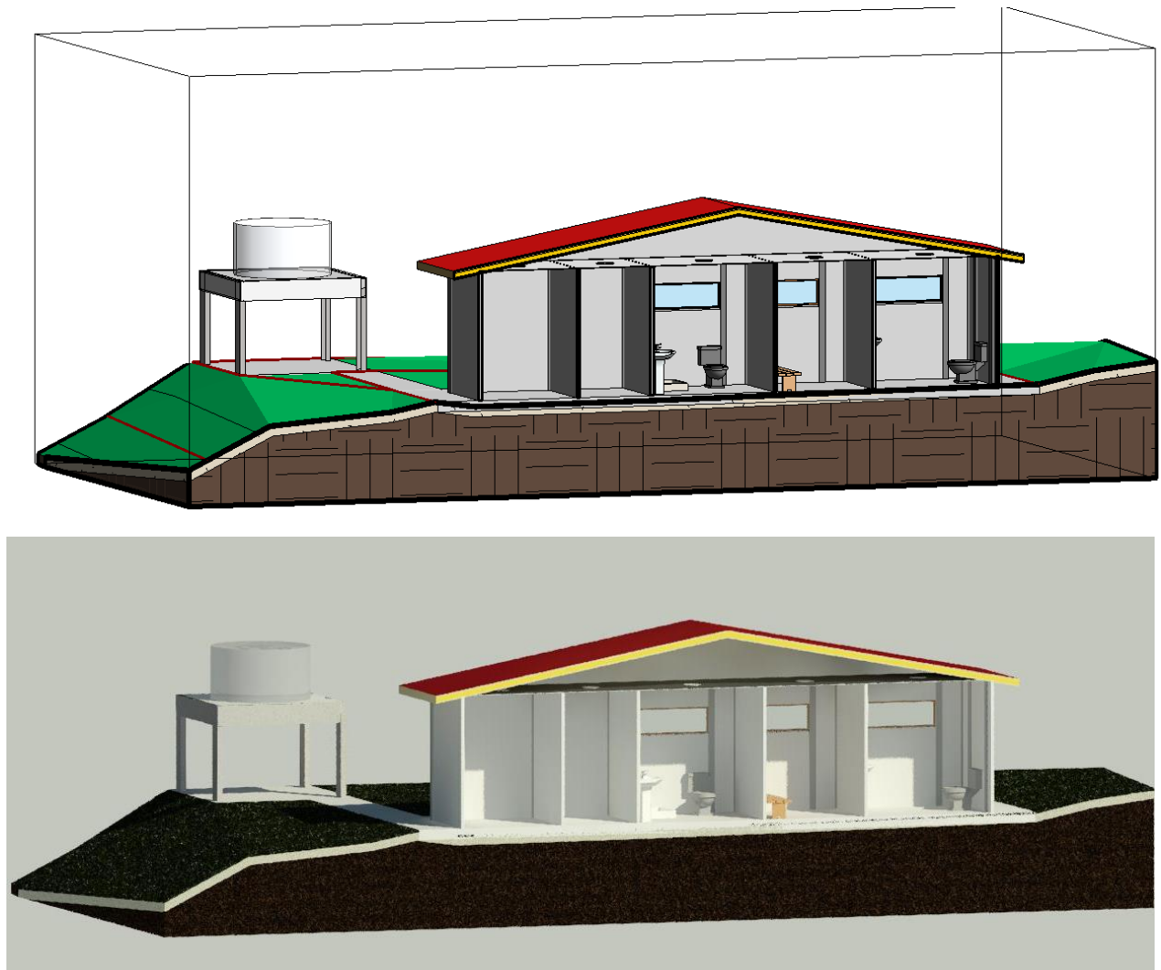
Figura 29. Vista del modelo as-built del interior del área de acopio (zona de bodega de utensilios, vestidores y baños) y de la plataforma del tanque de almacenamiento de agua del centro de manejo postcosecha de cacao y su respectivo render
