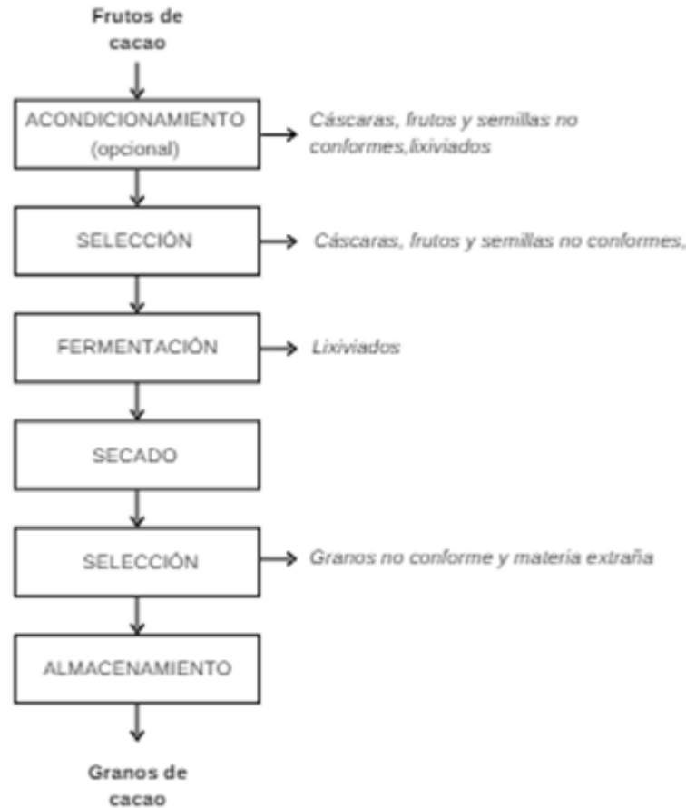
Figura 2 Flujo primario del proceso del cacao
