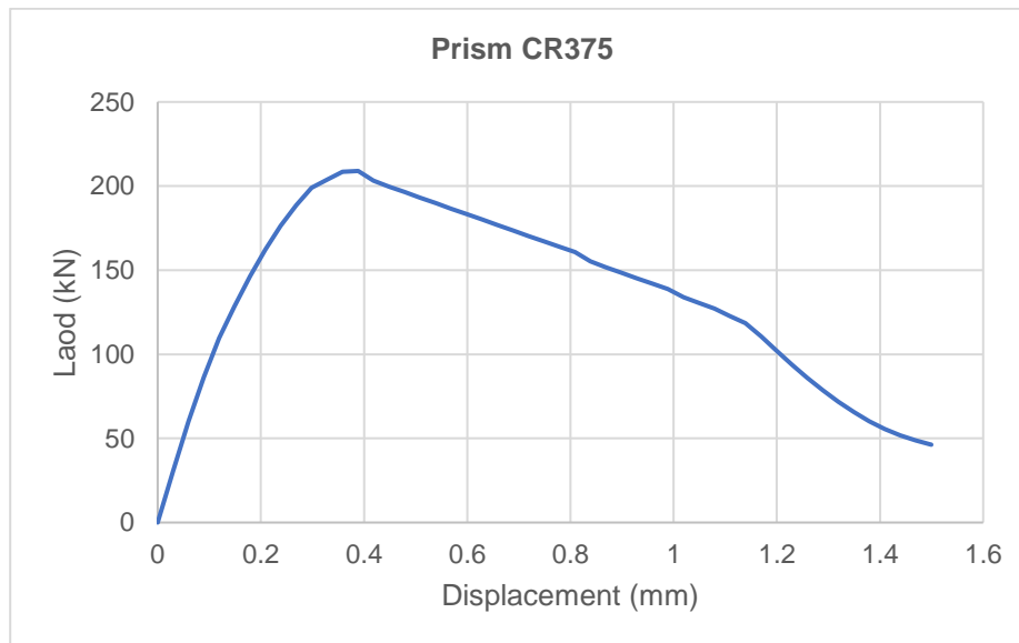
Figura 39. Curva teórica de carga vs. desplazamiento del cilindro CR375.
