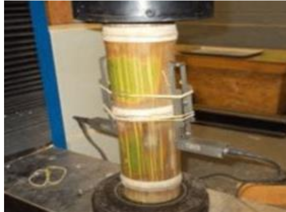
Figura 32. Probeta a compresión con deformímetro mecánico instalado.
