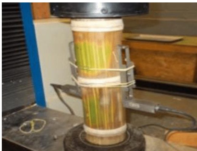
Figura 16. Probeta a compresión con deformímetro. Bambú Guadua angustifolia .
