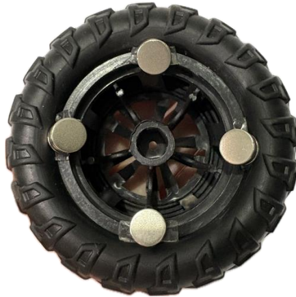
Figura 38. Posicionamiento de los cuatro imanes para sensado de velocidad angular.
