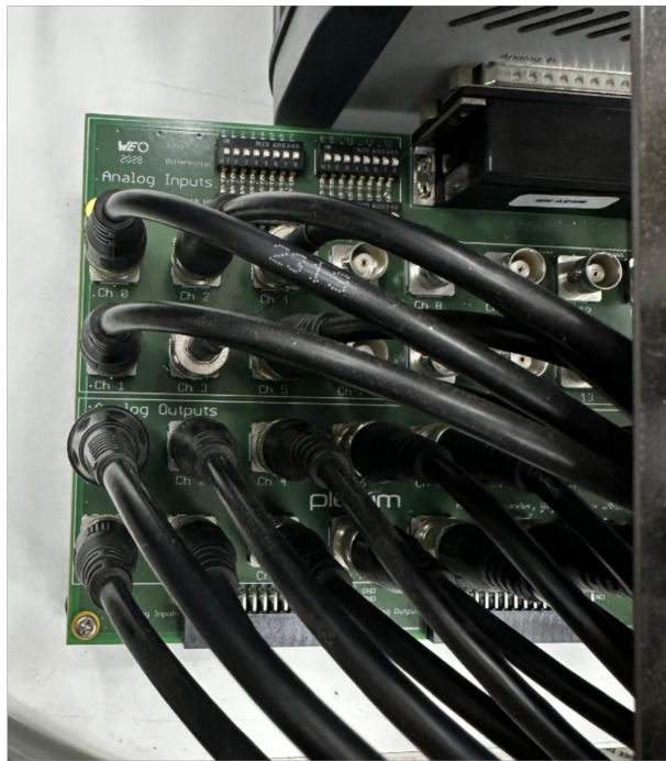
Figura 4.2: Tarjeta de entradas y salidas analógicas para el RTBox.
