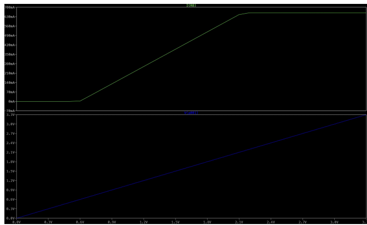
Figura 4.9: Resultado de simulación LTSpice para R5=2.2 \Omega .
