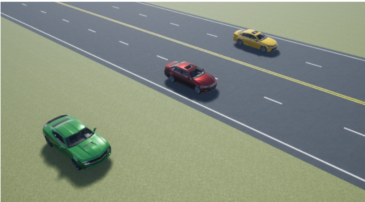
Figura 5.10: Escenario para la validación de la medición lateral de distancia relativa. Fuente: elaboración propia.
