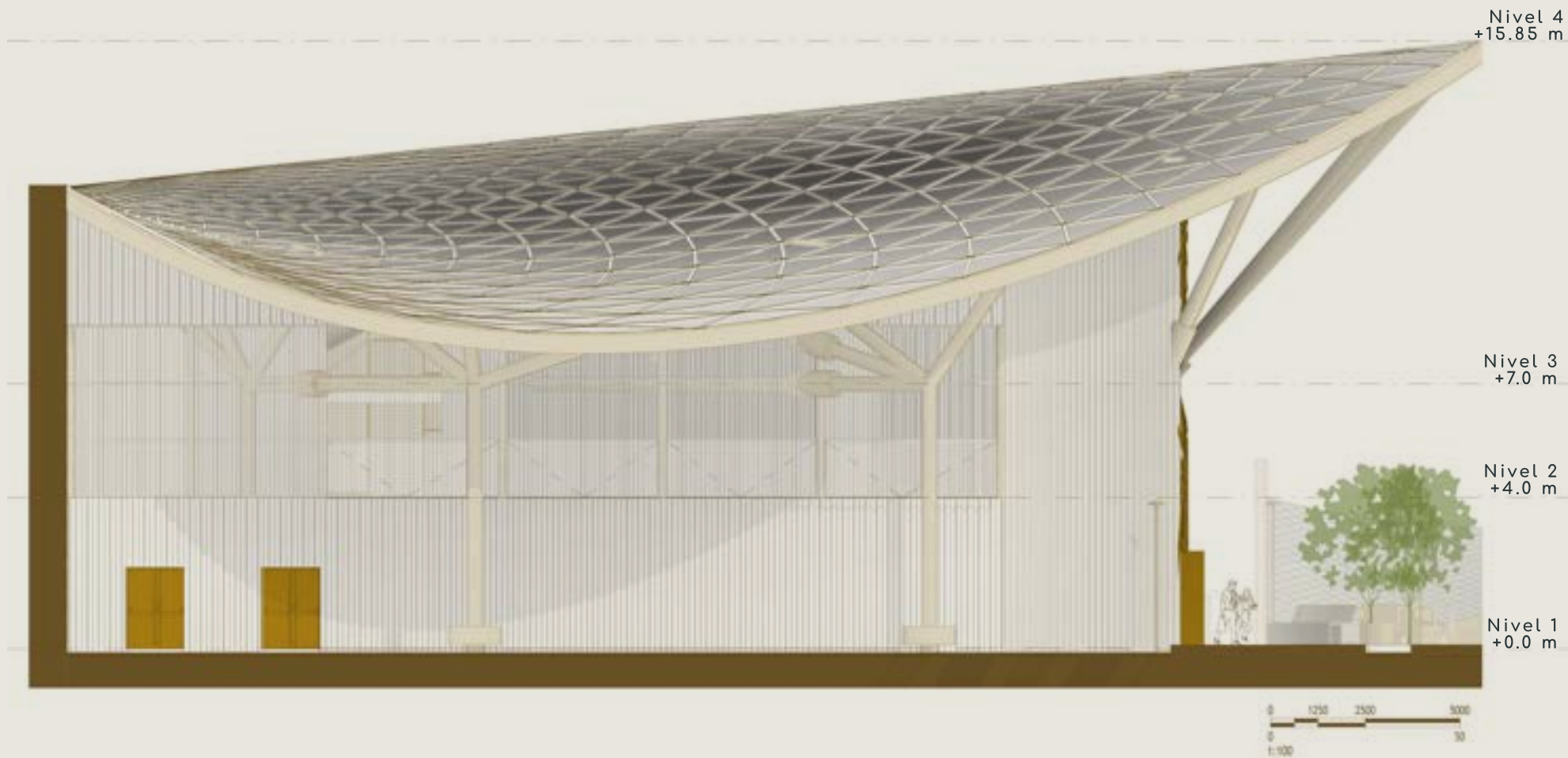
Figura 209 Fachada Sur Gimnasio Bajo Techo Nota. Elaboración propia
